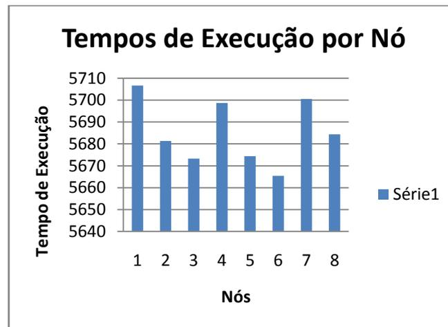
Figura 4.8: *Tempo de Execução das tarefas designadas a cada nó, para uma base NR, em 8 máquinas da PUC-Rio, com igual capacidade de processamento, para consulta com 500 seqüências e 500 aminoácidos cada.*
