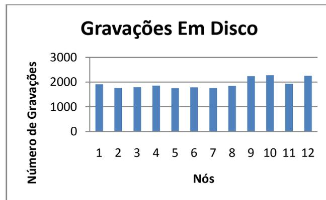
Figura 4.6: *Número de Gravações efetuadas em cada nó, durante a execução para uma base NT, em 12 máquinas, sendo 8 do tipo 1 e 4 do tipo 2, para consulta com 500 seqüências e 500 bases nucleotídicas cada.*
