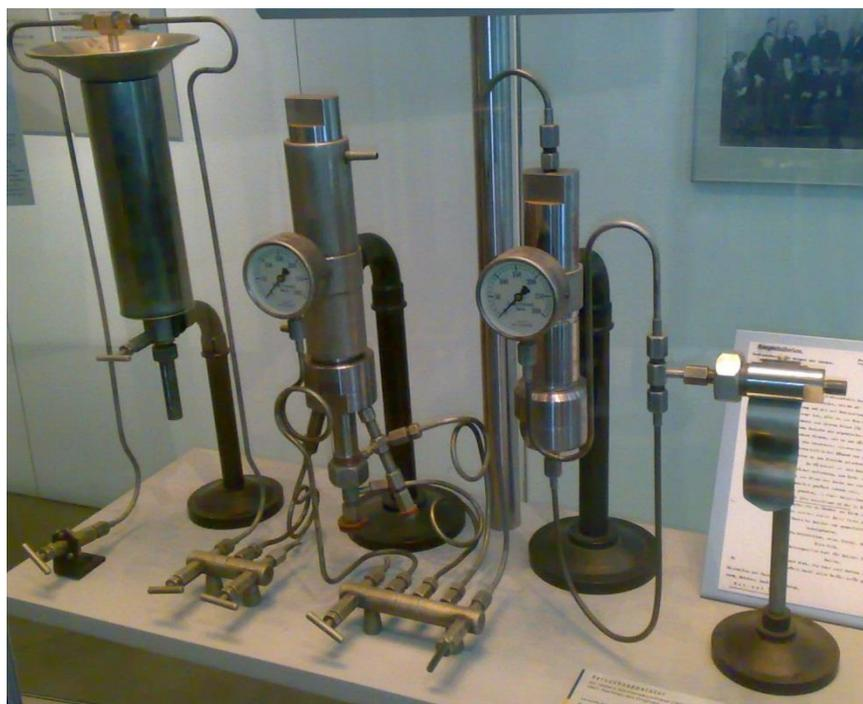
Figura 1: Primeiro sintetizador de amônia do mundo.
