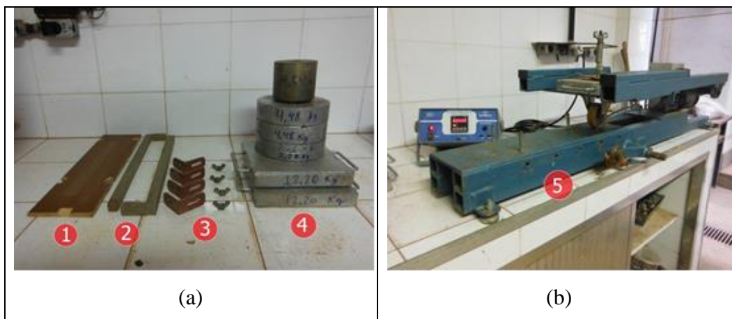
Figura 3-25 - Equipamento e ferramentas utilizadas durante a etapa de ruptura do corpo de prova
