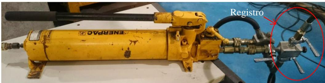
**Figura 4.33 - Bomba hidráulica com sistema de controle de aplicação de carga.**
