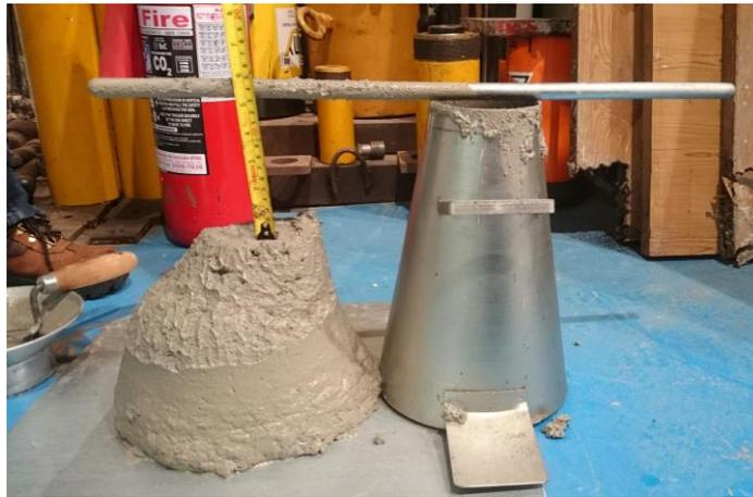
**Figura 4.16 - Realização do slump test.**
