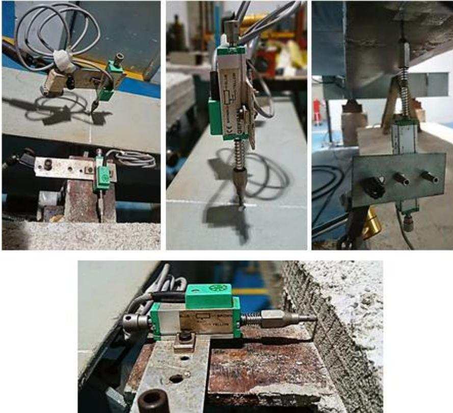
**Figura 4.25 - Transdutores de deslocamento posicionados: um vertical sobre cada apoio, um vertical no vão central e um horizontal em cada extremidade da viga.**
