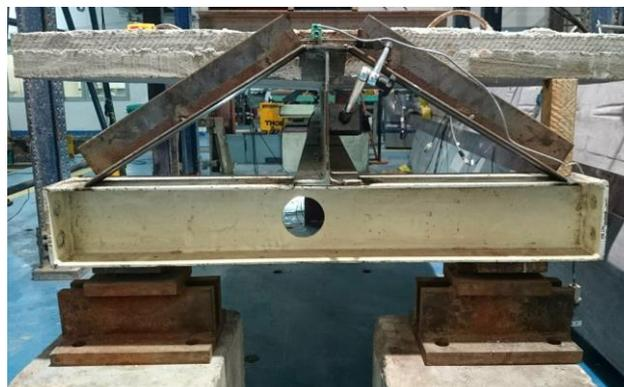
**Figura 4.19 - Detalhe do apoio do modelo 2.**
