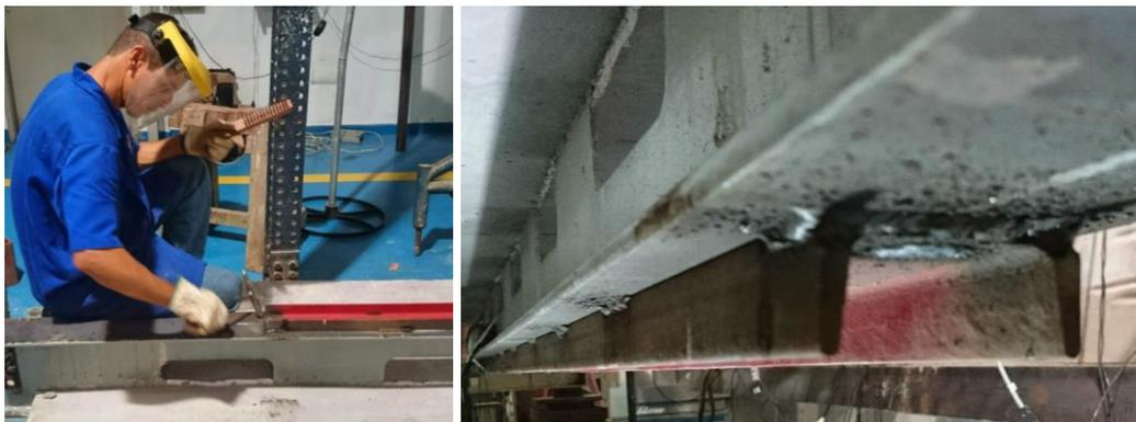
**Figura 4.18 - Perfil U soldado na mesa inferior da viga mista VM-02.**
