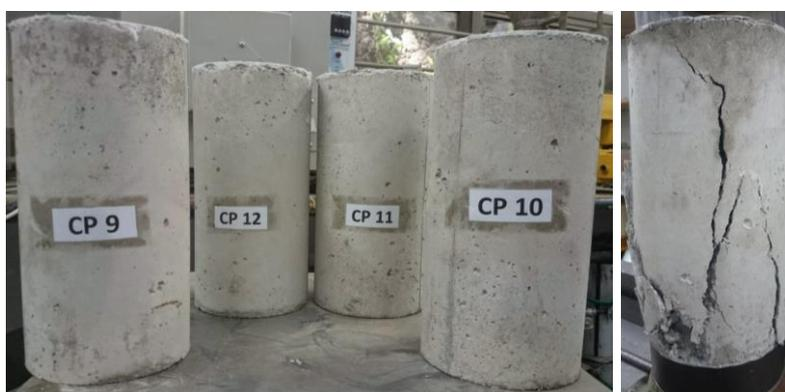
**Figura 4.20 - Corpos de prova a serem ensaiados aos 28 dias e corpo de prova após ensaio.**
