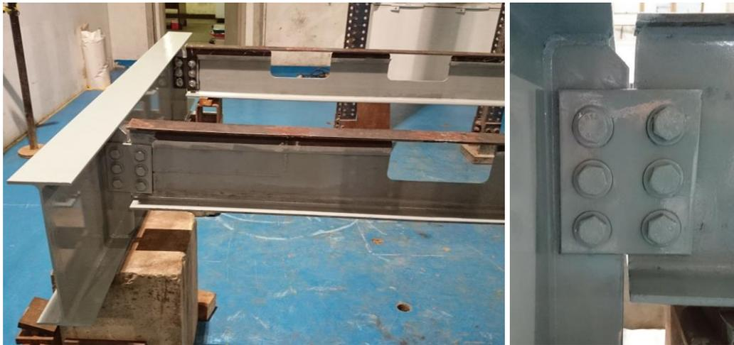
**Figura 4.13 - Ligação da Viga metálica com a viga de apoio.**
