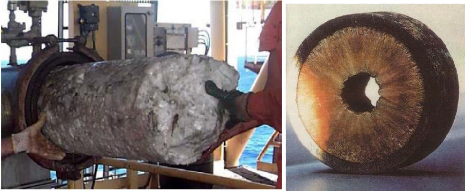
(a) Bloqueio por formação de hidrato (b) Bloqueio por deposição de parafina
