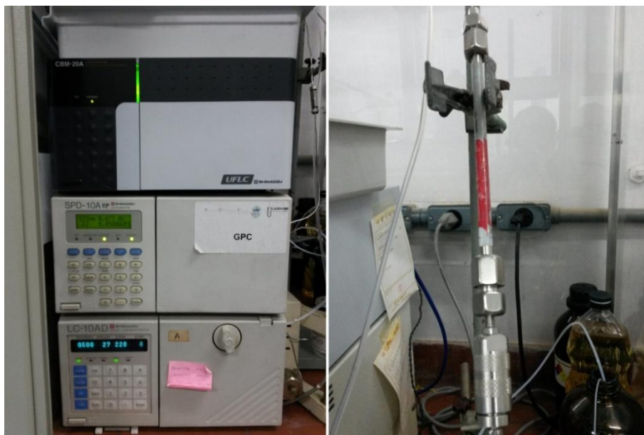
Figura 61 - Cromatógrafo LC-10AD (aparelho inferior), detector UV-VIS (aparelho intermediário) e controlador de sistema (aparelho superior), à esquerda. Coluna C18 acoplada a pré-coluna, à direita.
