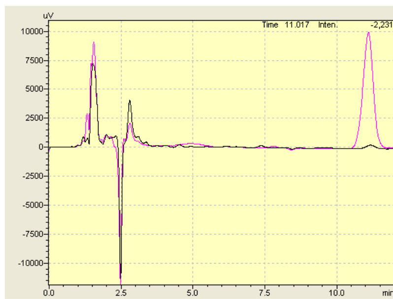
Figura 54 – Exemplo do cromatograma de uma amostra de campo para identificação do composto de 11,5 minutos
