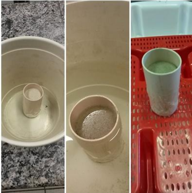
Figura 33 - Execução do ensaio de CRA
