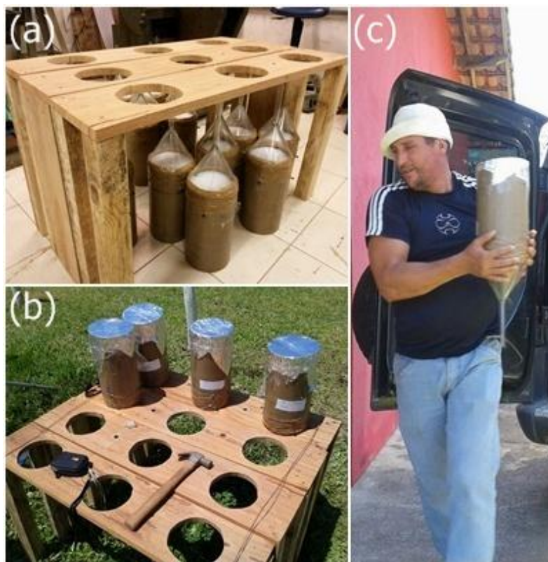
Figura 27 - Esquema e distribuição das colunas de PVC. Na figura (a), as colunas se encontram invertidas, com sua base mostrada para cima
