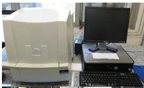
**Figura 47.** Espectrofotômetro Perkin Elmer, modelo Raman Itatian 400. Utilizado neste trabalho.
