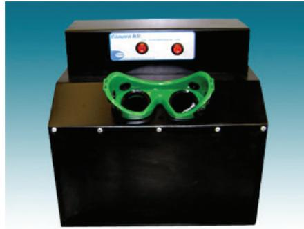
**Figura 42.** Câmara de radiação UV utilizada neste trabalho.
