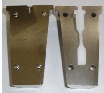
**Figura 40.** Molde aberto com o corpo de prova injetado.
