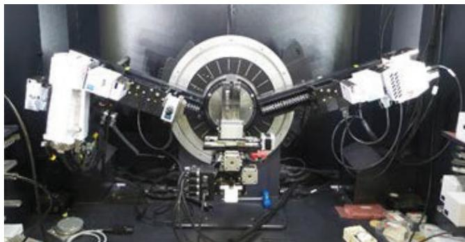
**Figura 44.** Difratômetro BRUKER, série D8 Discover, utilizado neste trabalho.
