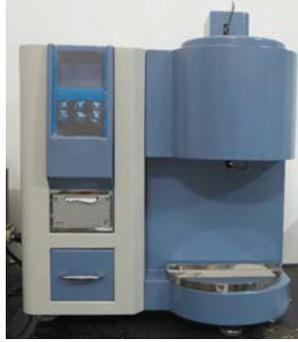
**Figura 48.** Plastômetro de extrusão *Melt Flow Indexer- Tinius Olsen* modelo MFI – 410, empregado neste trabalho.
