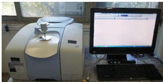
**Figura 46.** Espectrômetro infravermelho Perkin Elmer, modelo Spectrum 400.
