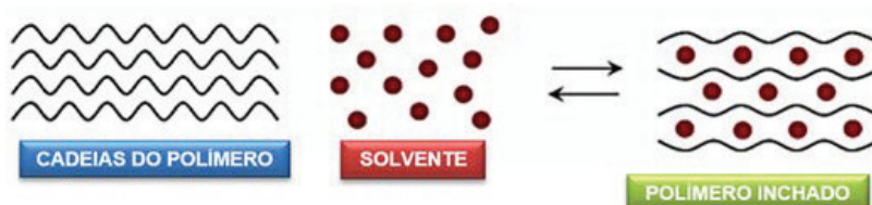
Figura 35. Representação esquemática da difusão de um líquido dentro de um polímero [35].
