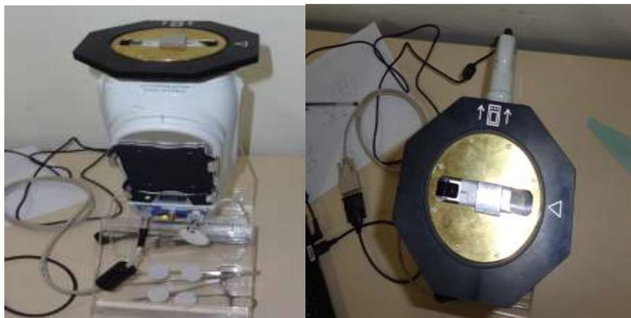
Figura 20 – Ensaio de fluorescência de raios X.
