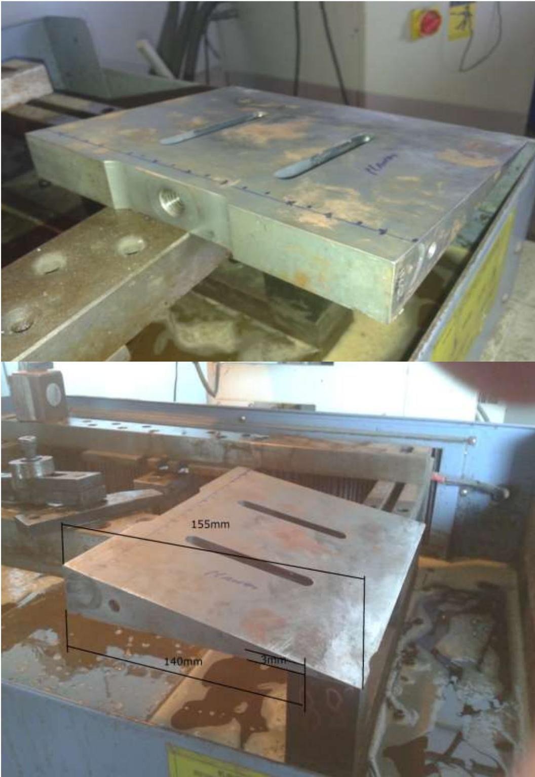
Figura 21 – Retirada dos espécimes no sentido da laminação
