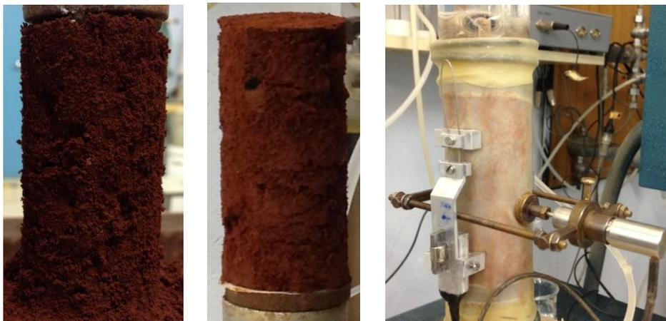
Figura 5.51 – Corpos de prova utilizado no ensaio triaxial.
