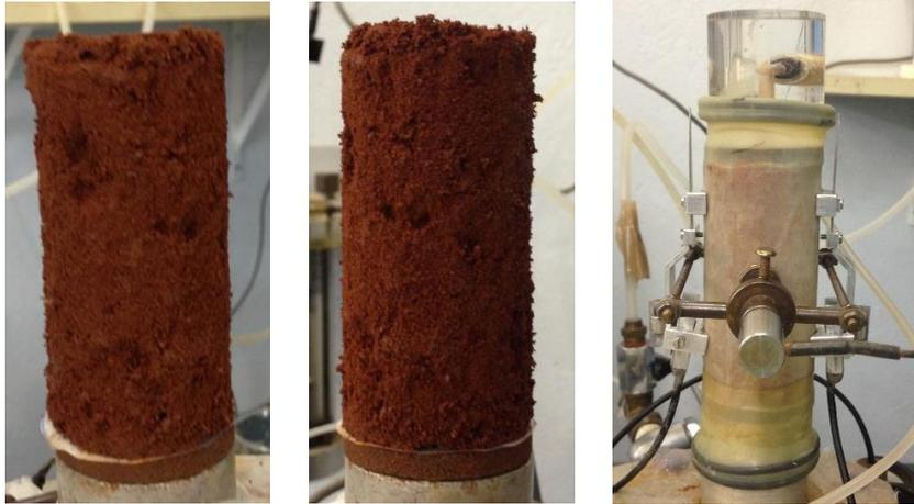
Figura 5.44 – Corpos de prova utilizado no ensaio – Solo 1,5m.
