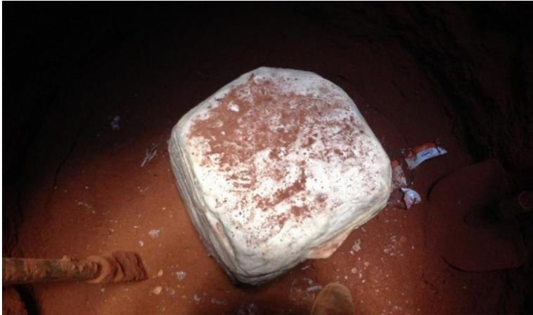
Figura 5.13 – Amostra indeformada à 3,5m de profundidade.
