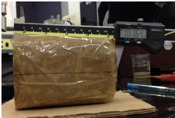
Figura 5.69 – Exemplo do corpo de prova prismático utilizado no ensaio geofísico.
