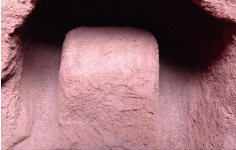
Figura 5.12 – Amostra indeformada à 1,5m de profundidade.
