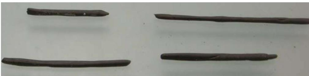
Figura 4.23 – Cilindros moldados no ensaio de limite de plasticidade.
