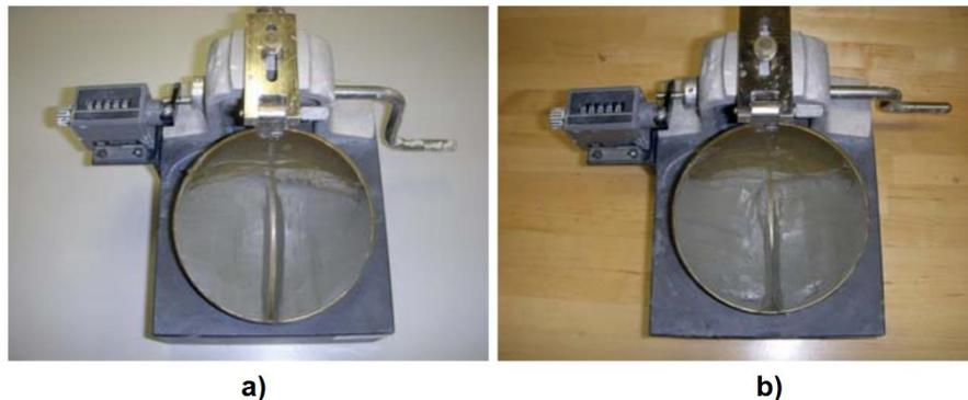
Figura 4.22 – Ensaio de limite de liquidez – a) Sulco aberto no solo – b) Sulco fechado.
