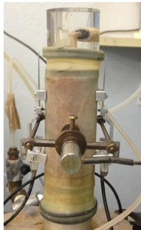
Figura 4.39 – Medidores de deformação local utilizados.
