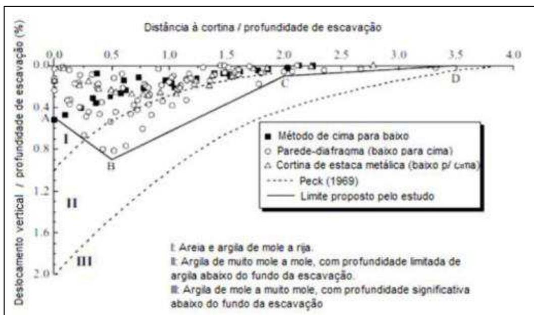
**Figura 27. Valores de recalques superficiais obtidos por Wang *et al.* (2010), plotados no gráfico proposto por Peck (1969).**
