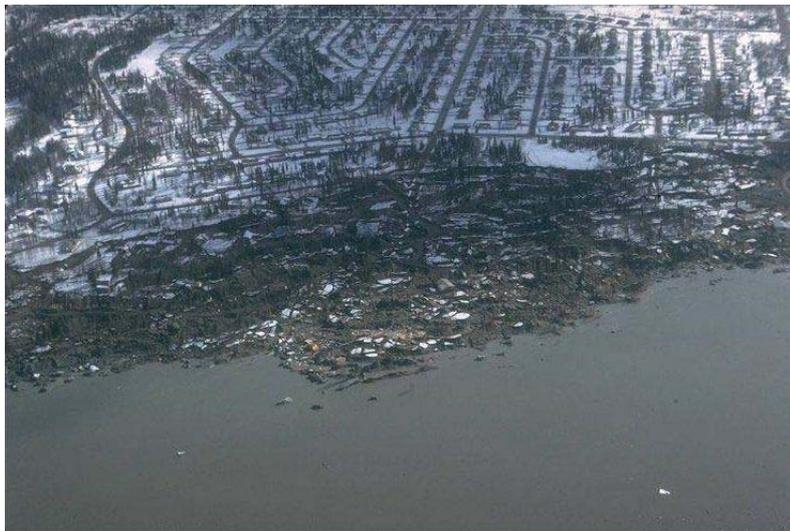
Figura 1.2 - Liquefação do solo no terremoto Good Friday, Alaska - EUA, 1964, causando grandes movimentos de massas [Earthquake Engineering Research Center, University of California, Berkeley, USA].
