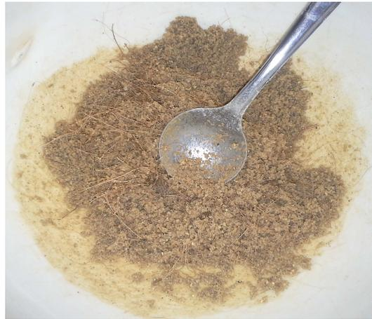
**Figura 6:** Processo de mistura solo - fibra.
