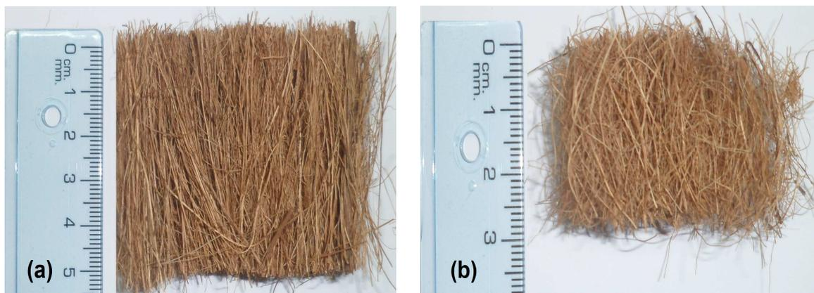
**Figura 5:** Cortes da fibra de coco, (a) comprimento 50 mm, (b) 25 mm.
