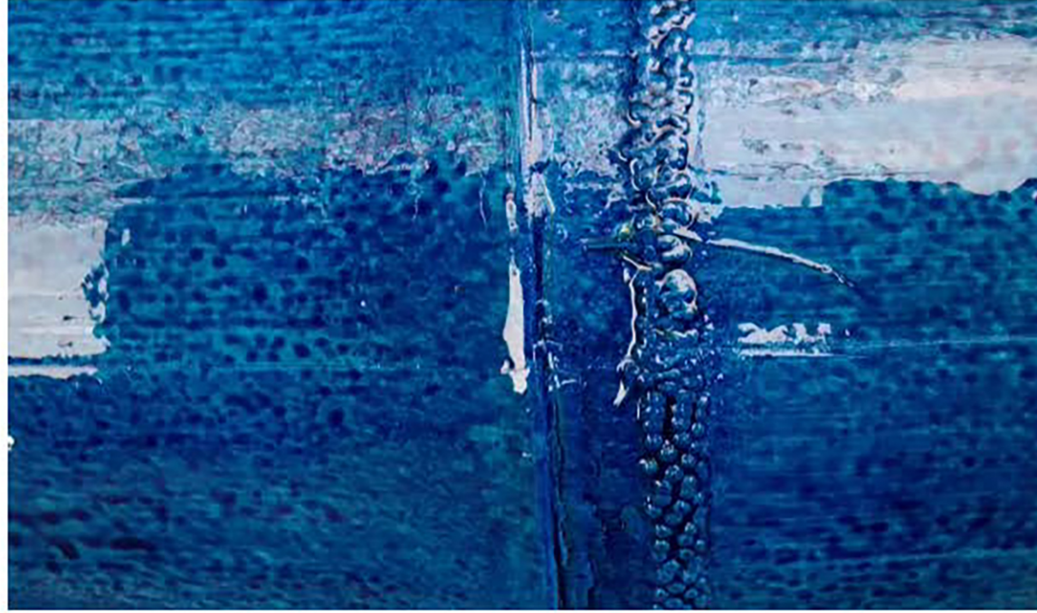
1 demão PVA diluído (1/6) + 1 demão PVA diluído com pigmento óxido líquido (1/4 e 1/20) + resina (3 demãos). Colmo face convexa, espécie Dendrocalamus Giganteus . Obs.: o azul é pintado com rolo; o verde com trincha.
