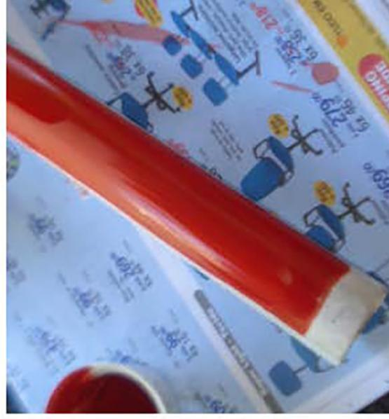
Experimentos em seções entrens de colmos abertos de bambu *Phyllostachys*. Os dois pigmentos – verde e vermelho – foram cedidos pelo Ripper, não havendo registro de origem. Ambos dissolverem em acetona. Na solução foi adicionado o produto Paraloid (pequenas cápsulas, como mostrado na prancha 2.6.1 cujo solvente também é a acetona). (p.73)
