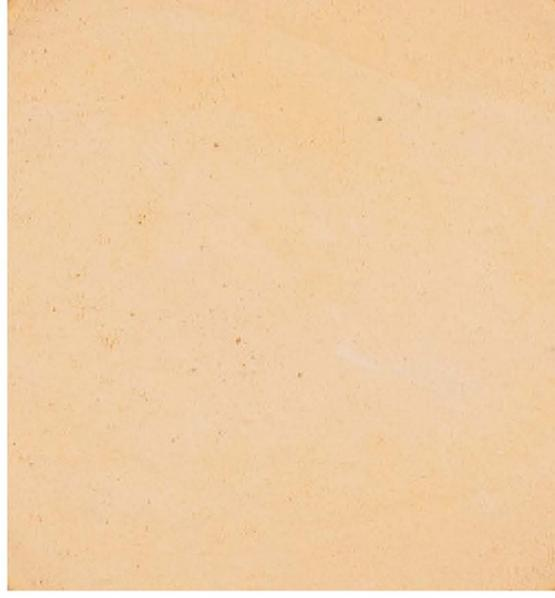
Terras peneiradas e decantadas em carga de gesso. As tonalidades de cor e texturas podem simular a pigmentação em carga de cal, seja em estado pastoso ou líquido. (p.63)
