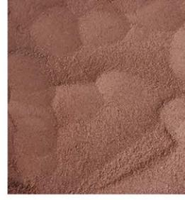
Corpo de prova formado por quatro partes abertas de uma seção entre nós de colmo de bambu mossô. Os 16 módulos demarcados mostram resultados da interação terra/resina, provocados por técnicas e superposições variadas. Na realização do modelo foram usadas as mesmas terras coletadas na pesquisa de mestrado, mostradas na prancha 1.1.2. (p. 14)
