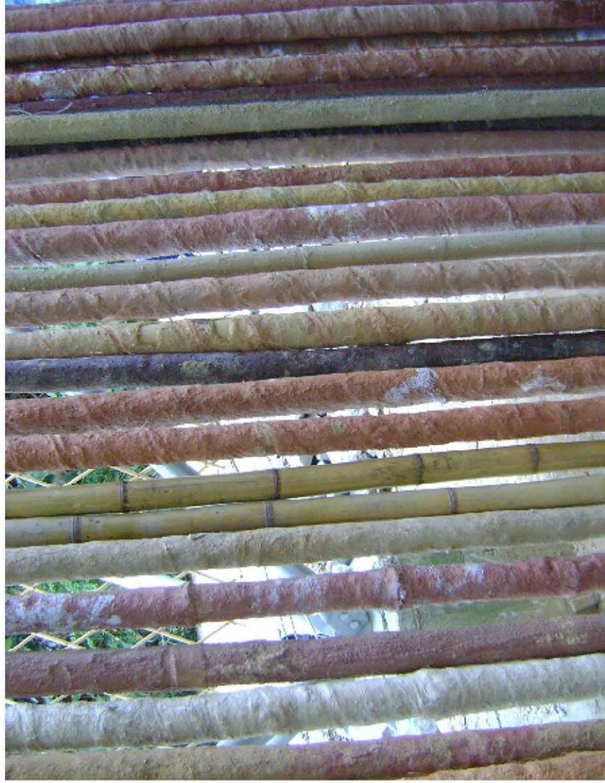
Corpos de prova utilizados nos primeiros experimentos: bambus da espécie *Phyllostachys*, 3 a 4 cm de diâmetro, 3 m de comprimento; encobrimento com tecidos e terras de diferentes tonalidades de cor. (p.12)
