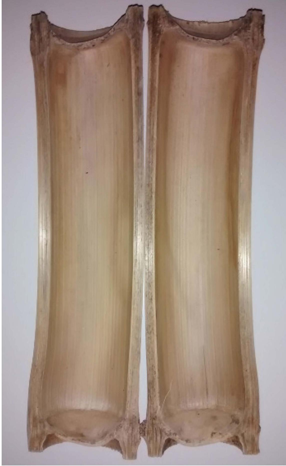
As curvaturas únicas em uma seção entre nós do colmo de um bambu *Vulgaris* aberto. (p.26)
