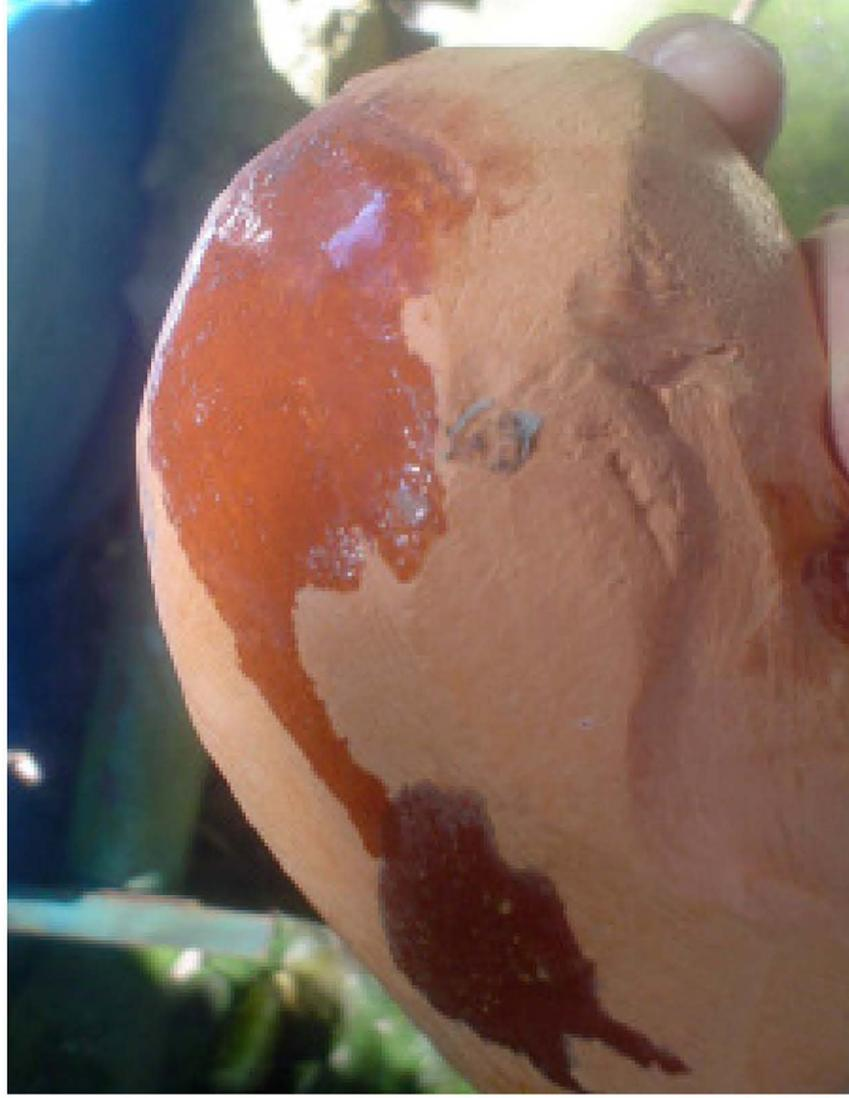
Resina poliuretana de mamona e resina epóxi (mancha menor, mais escura) aplicadas sobre barro de modelagem ressecado, endurecido. Observa-se a maneira como a resina é absorvida pela terra. Escurecimento, uniformização e alteração da textura. (p.14)
