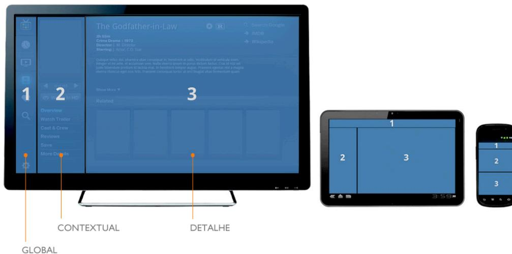
Figura 29: diferentes maneiras de interagir em cada contexto de uso - telas maiores versus telas menores e posicionamento da navegação global, da navegação contextual e do detalhe em cada uma destas telas.
