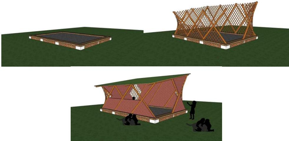
Figura 157: Desenho geral da sala de aula ilustrando o processo construtivo, 2012-2013.
