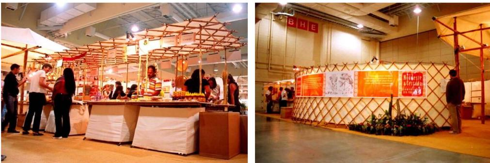
Figuras 1 e 2: Treliça pantográfica, unidades em jogo formando objetos provisórios com diferentes funções, teto (1) e parede divisória (2), Sala Nordeste-Cerrado, Bambutec Design, São Paulo, 2007.
