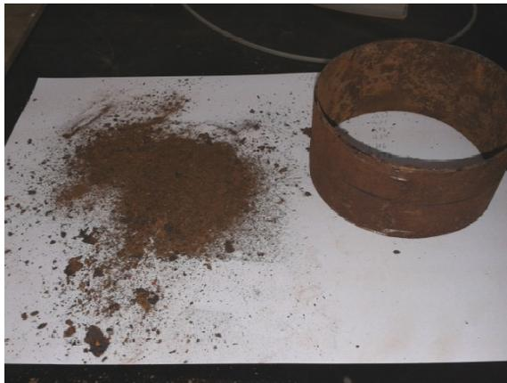
Figura 4.5 – Oxidação interna do tubo
