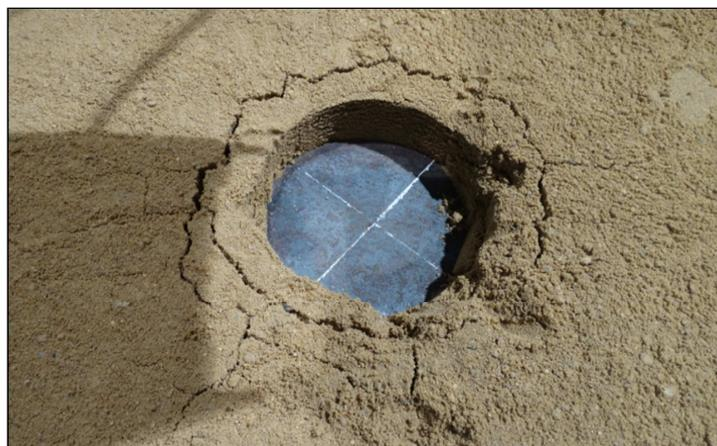
**Figura 4.50 - Mecanismo de ruptura localizada da areia sem fibra**
