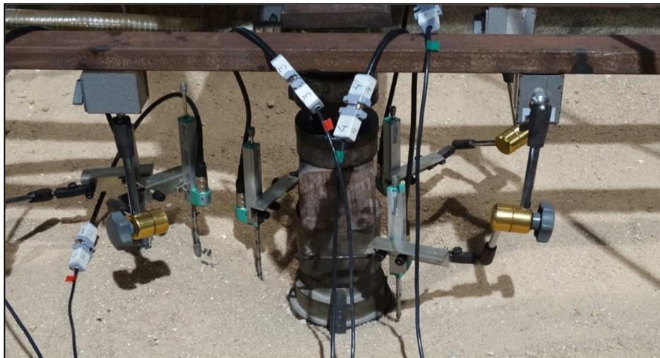
**Figura 4.7 - Posição final dos equipamentos - Areia Seca**
