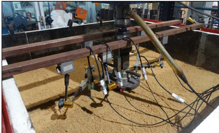
**Figura 4.14 - Colocação dos transdutores de deslocamento**
