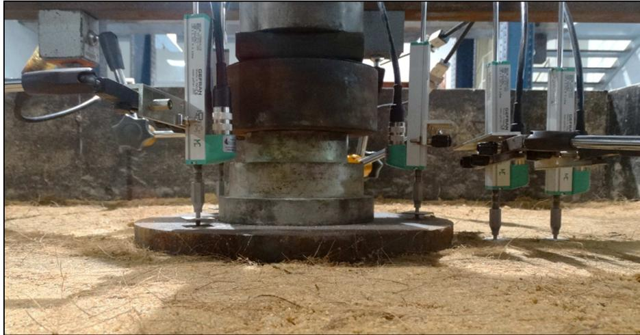
**Figura 4.28 - Posição inicial dos transdutores de deslocamento (fibra aleatória)**
