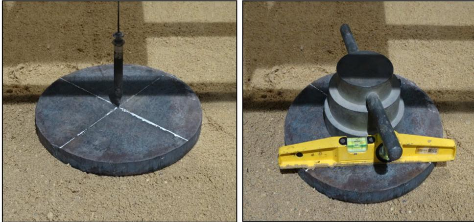
**Figura 4.13 - Nivelção vertical e horizontal da placa de aço**
