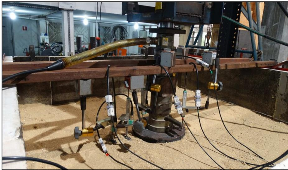
**Figura 4.6 - Posição inicial dos equipamentos - Areia Seca**
