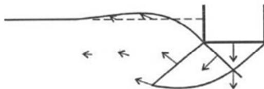
**Figura 4.46 - Campo de deslocamento da ruptura localizada**
