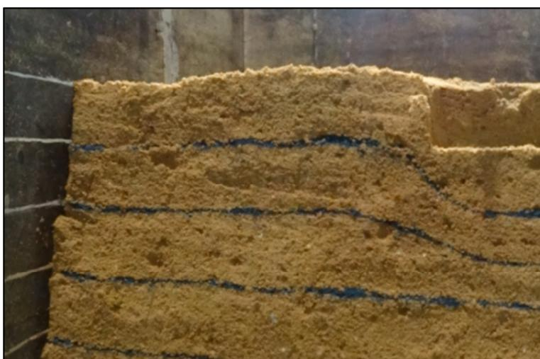
**Figura 4.47 - Campo de deslocamento do ensaio 2 (areia úmida)**
