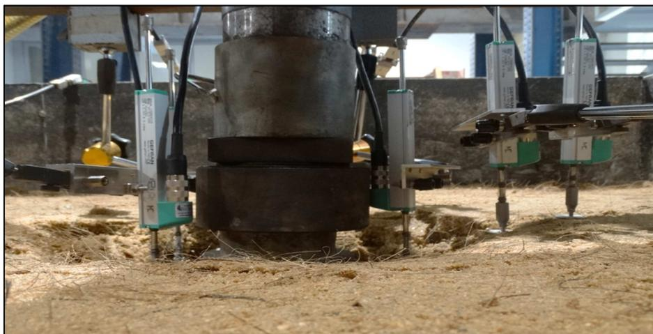
**Figura 4.29 - Posição final dos transdutores de deslocamento (fibra aleatória)**
