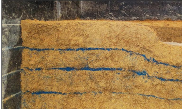
**Figura 4.49 - Campo de deslocamento do ensaio 4 (fibra aleatória)**
