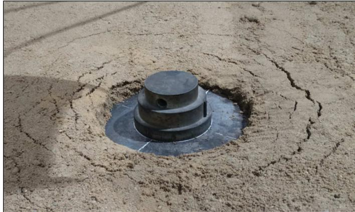
**Figura 4.51 - Mecanismo de ruptura por punção da areia com fibra em manta**
