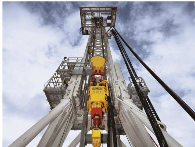
Figura 1.3. Esquema de topdrive em sondas de perfuração offshore. Disponível em: < [www.drillingcontractor.org](http://www.drillingcontractor.org) >. Acesso em: 24 jan. 2014
