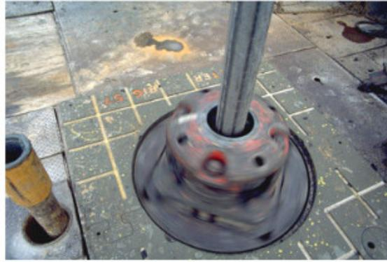
Figura 1.2. Mesa rotativa rotaciona provendo giro ao tubo de perfuração. Disponível em: < [papeandoetestado.blogspot.com](http://papeandoetestado.blogspot.com) >. Acesso em: 12 jan. 2014.
