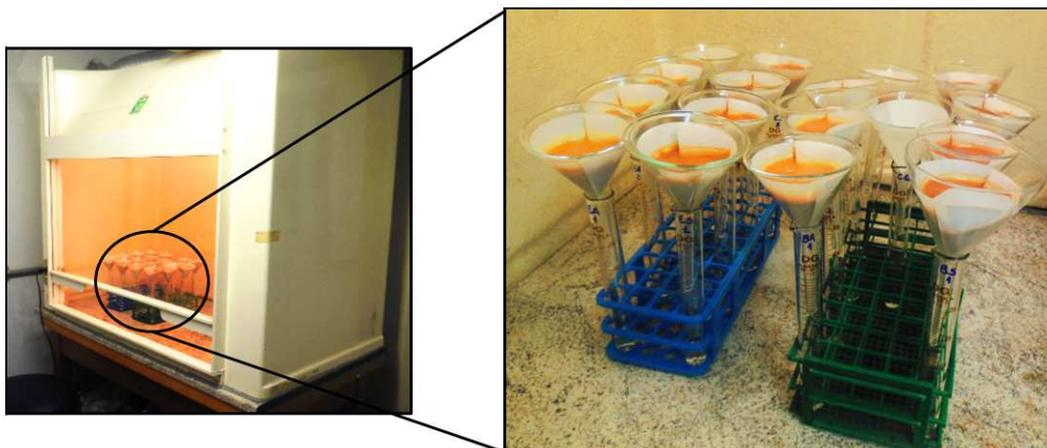
Figura 14: Processo de filtragem no interior da capela de exaustão
