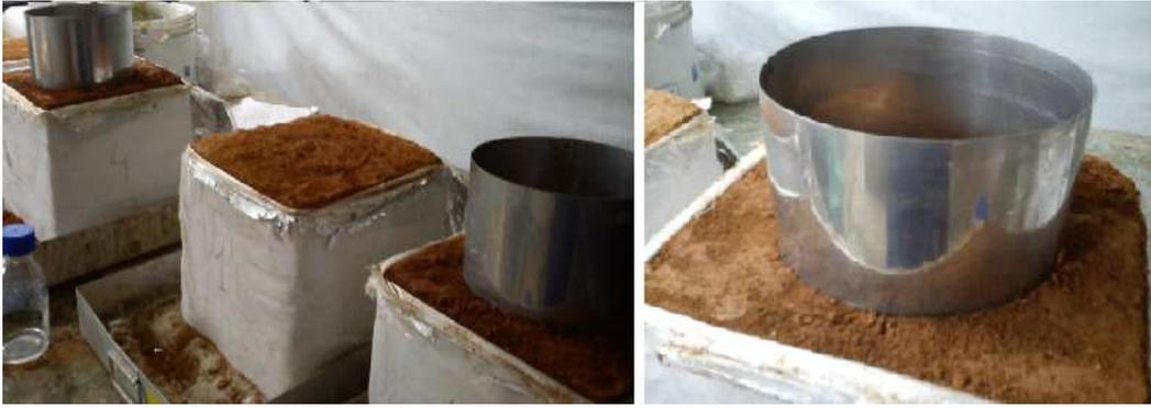
Figura 9: Contaminação dos blocos indeformados utilizando anéis metálicos.
