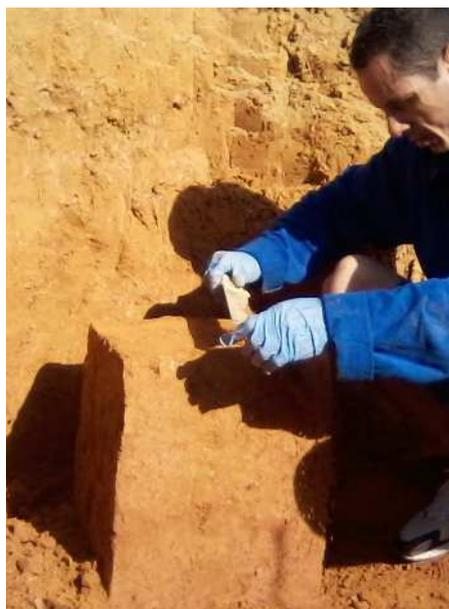
Figura 10: Moldagem dos blocos em campo.
