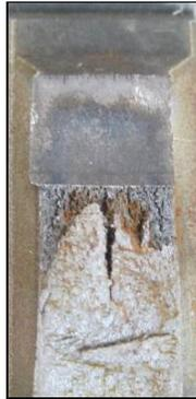
Figura A.8 – Superfície de fratura CP SEB-05-02.
