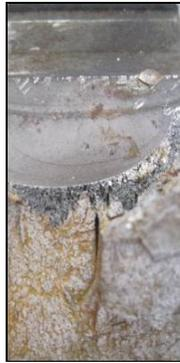
Figura A.9 – Superfície de fratura CP SEB-05-03.
