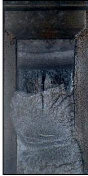
Figura A.4 – Superfície de fratura CP SEB-04-01.
