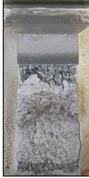
Figura A.10 – Superfície de fratura CP SET-04-01.
