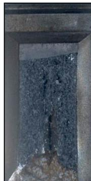
Figura A.3 – Superfície de fratura CP SEB-03-03.
