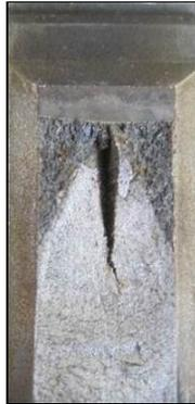
Figura A.1 – Superfície de fratura CP SEB-03-01.
