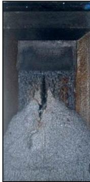
Figura A.5 – Superfície de fratura CP SEB-04-02.
