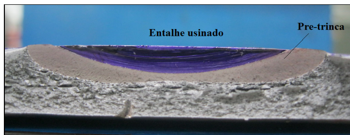
Figura 6.15 – Pré-trinca aproximadamente semielíptica placa A12-01.
