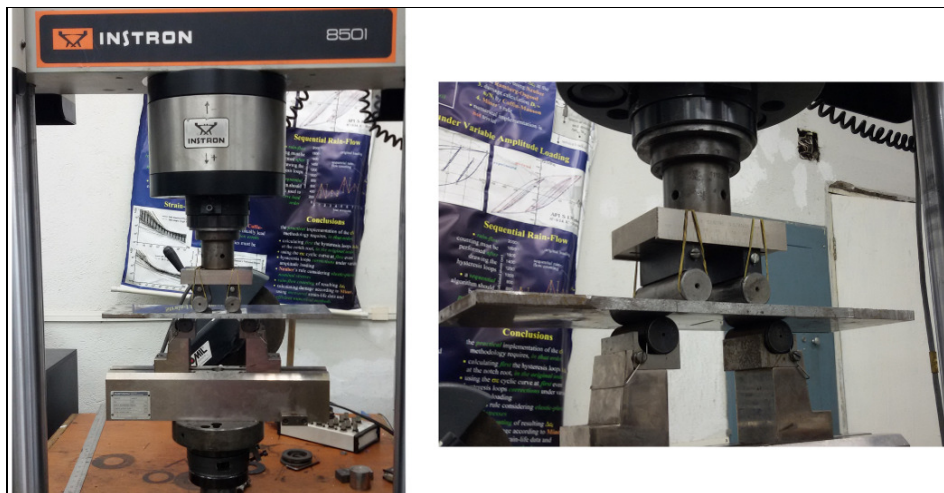
Figura 6.13 – Máquina e equipamentos usados no pré-trincado.
