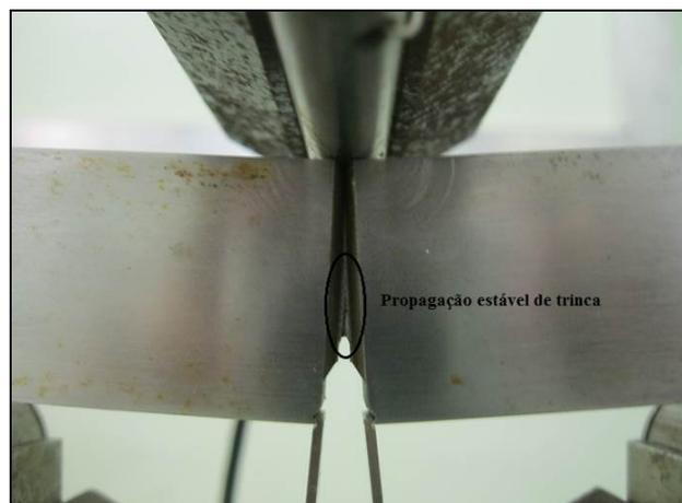
Figura 5.22 – Propagação estável da trinca.
