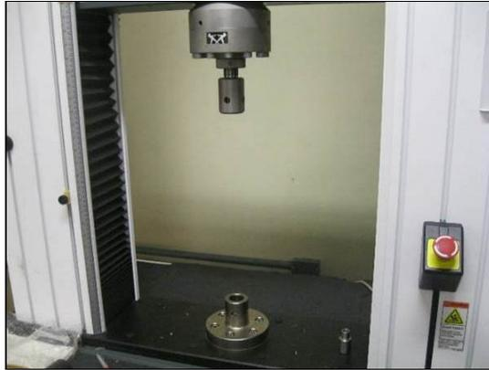
Figura 5.4 – Máquina de tração INSTRON 8872.
