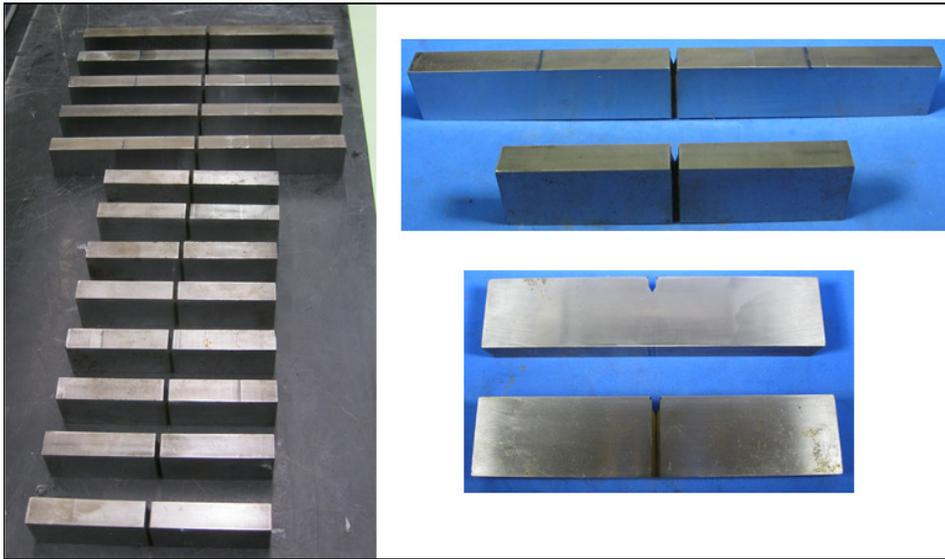
Figura 5.14 – Conjunto de CPs entalhados lateralmente.
