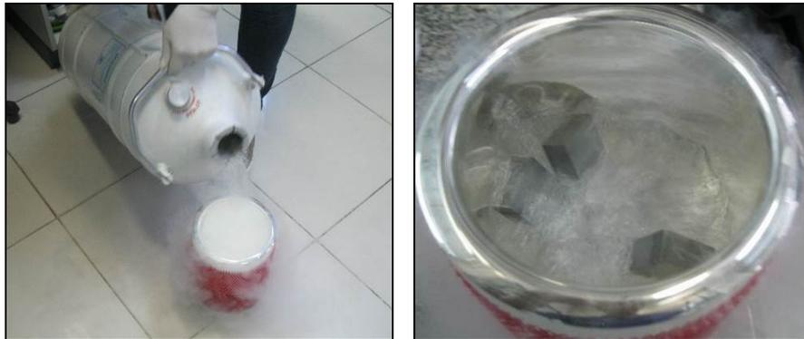
Figura 5.31 – CPs submersos em nitrogênio líquido para fratura.
