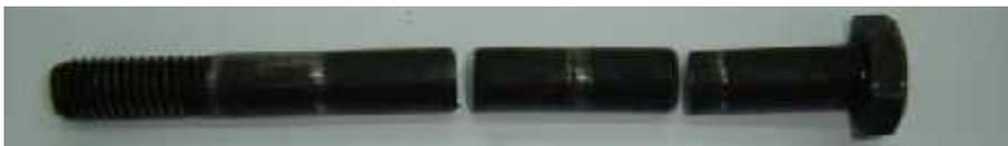
Figura 5.8 – Parafuso após a ruína sem rosca nos dois planos de corte.
