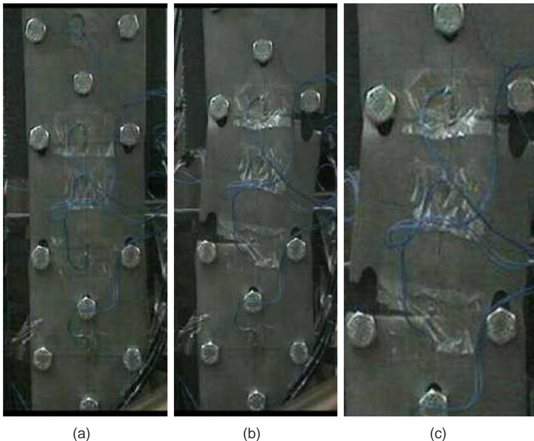
Figura 4.43 – Ensaio 28: (a) início do ensaio, (b) alargamento dos furos, (c) ruptura.
