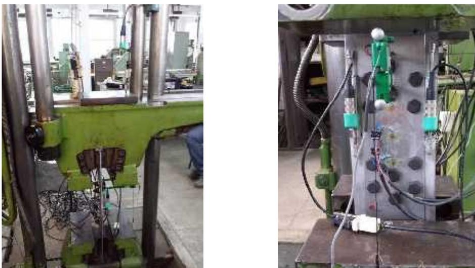
Figura 4.71 – Detalhe da chapa interna e posicionamento dos transdutores de deslocamento e clipgage.
