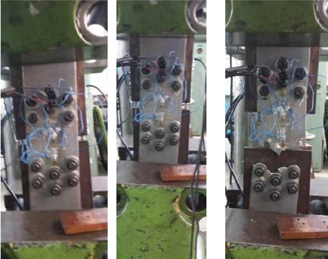
Figura 4.79 – Ensaio 44: (a) configuração inicial, (b) deformação limite, (c) ruptura.
