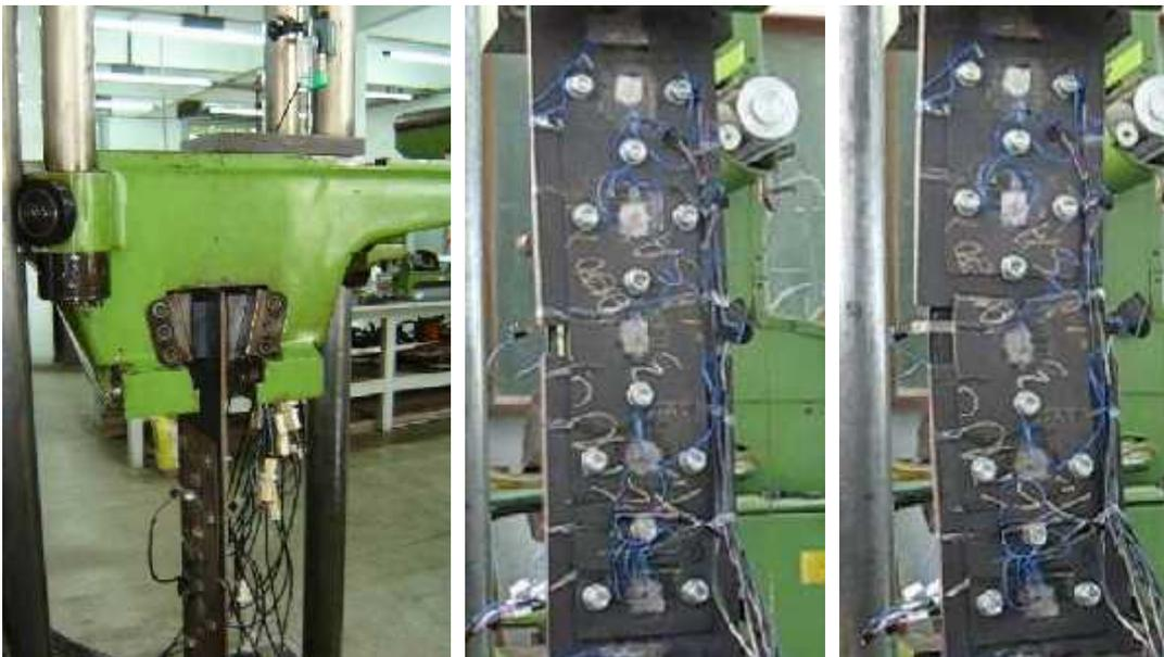
Figura 4.35 – Ensaio 10: (a) posicionamento, (b) configuração inicial, (c) ruptura.
