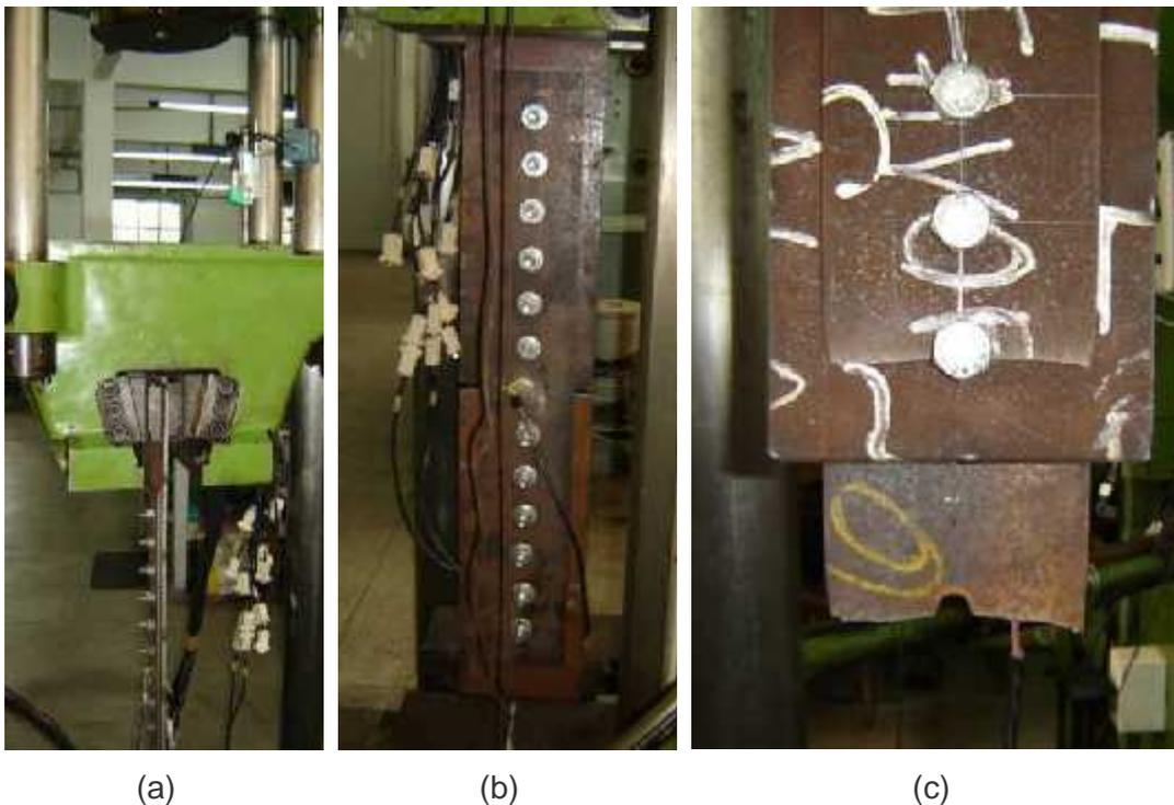
Figura 4.30 – Ensaio 22: (a) Posicionamento, (b) configuração inicial, (c) ruptura.
