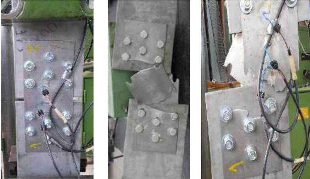
Figura 4.64 – Antes do ensaio e após a ruptura.
