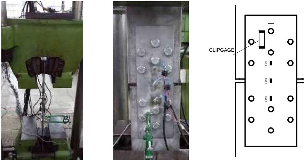
Figura 4.73 – Detalhe da chapa interna e posicionamento dos LVDT e clipgauge.
