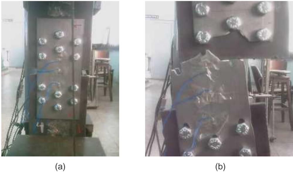
Figura 4.41 – (a) configuração inicial, (b) após a ruptura.
