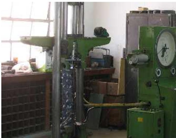
Figura 3.15 – Máquina universal de ensaios Lousenhausen 600 kN.
