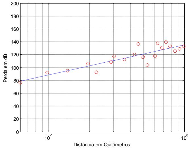
Figura 8.5 - Retas de ajuste para 750 MHz a 6 metros de altura de transmissão.
