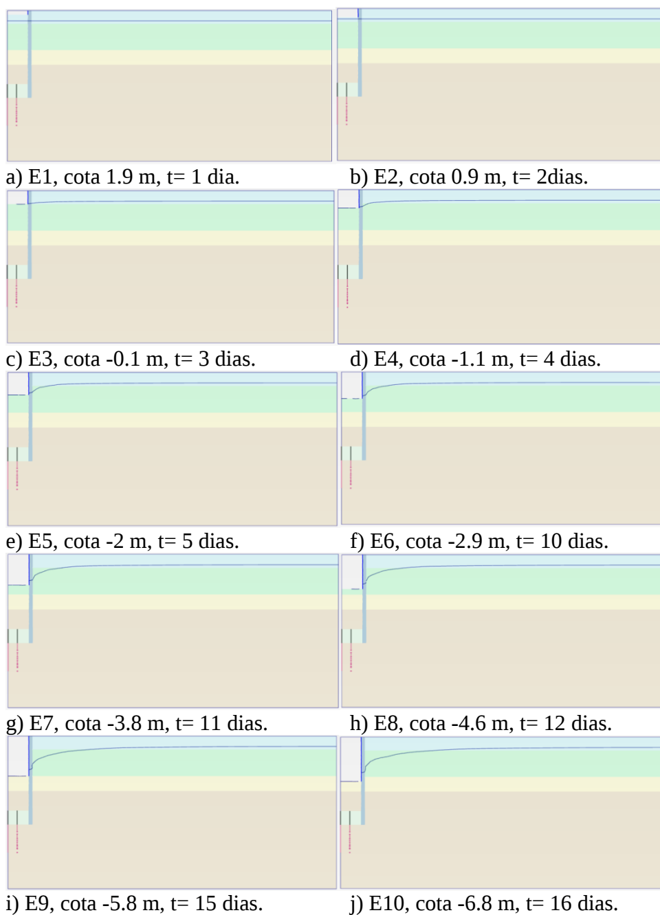
Figura 4.23 - Descenso do nível freático (correspondente às 10 primeiras etapas da análise de adensamento), conforme o avanço da escavação do poço.
