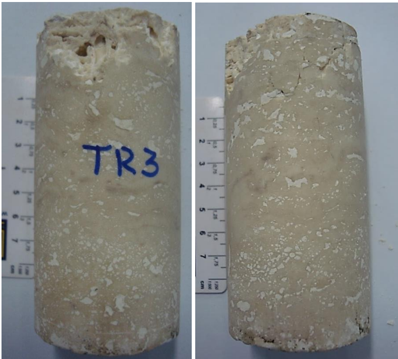
Corpo de prova TR3 com fratura do tipo fendilhamento e colapso de poros.
