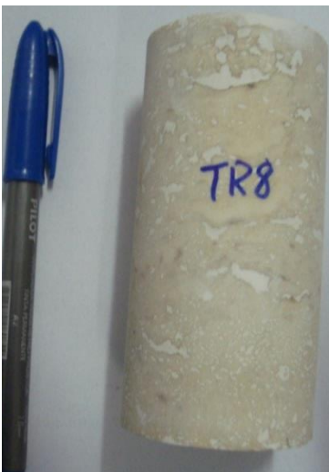
Corpo de prova TR8 e seu perfil da porosidade.
