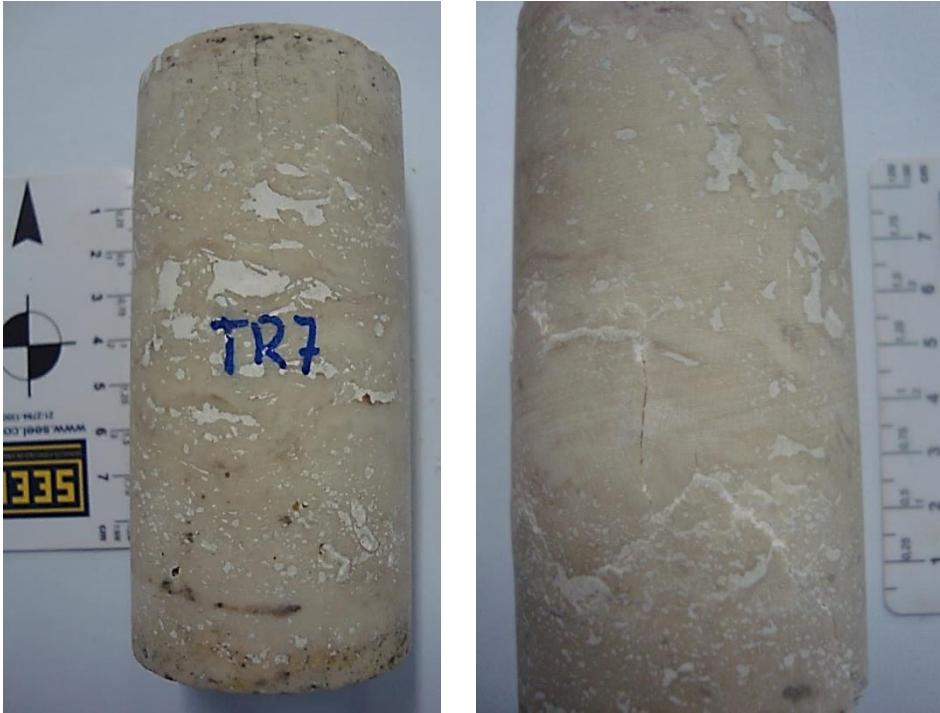
Corpo de prova TR7 com fratura do tipo fendilhamento e TR8 com fratura cisalhante e gretas verticais características da fratura do tipo fendilhamento.
