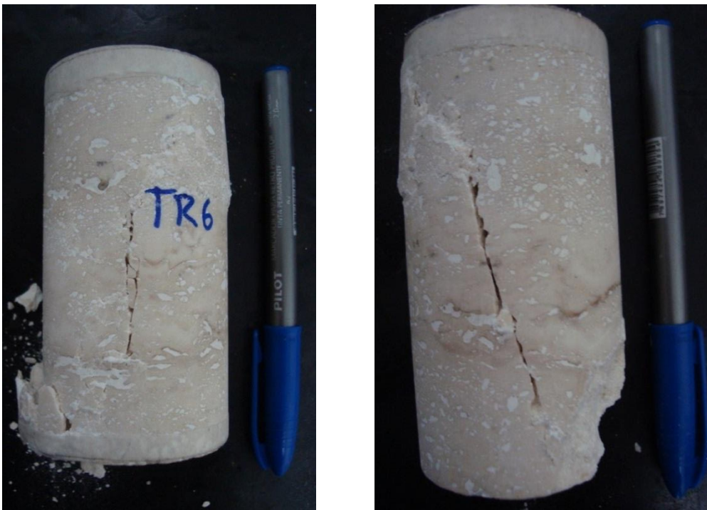
Corpo de prova TR6 mostrando a fratura cisalhante após do ensaio triaxial.
