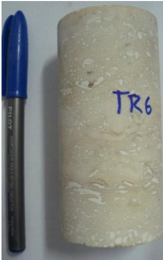
Corpo de prova TR6 e seu perfil da porosidade.
