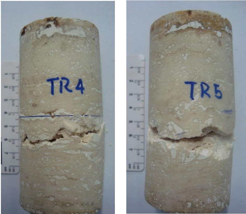
Corpo de prova TR4 e TR5 fraturados pela ocorrência do colapso de seus poros.
