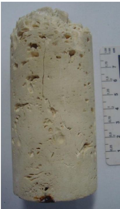
Corpo de prova TR13 com fratura do tipo fendilhamento e colapso de poros.
