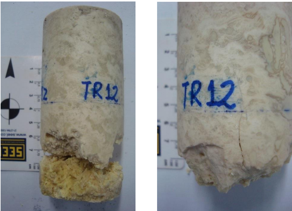
Corpo de prova TR12 mostrando o colapso de seus poros e gretas características da fratura do tipo fendilhamento.
