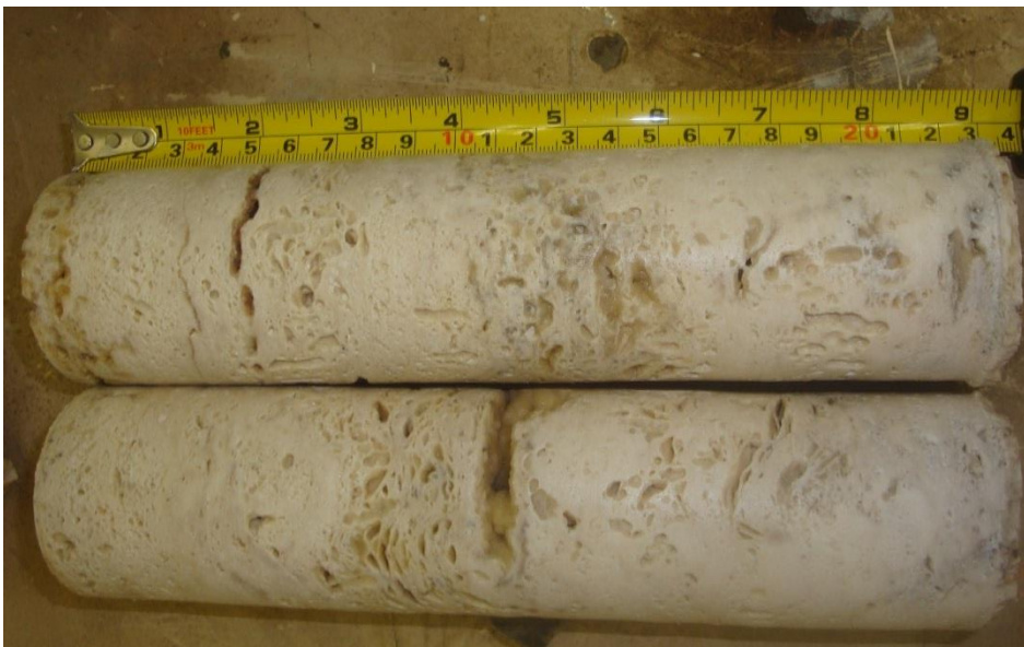
Figura 5.21 Plugues NX (54 mm) com poros maiores aos registrados no micro-tomógrafo.
