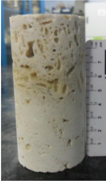
Figura 5.10 Fácies massiva e bandeada presentes no travertino.
