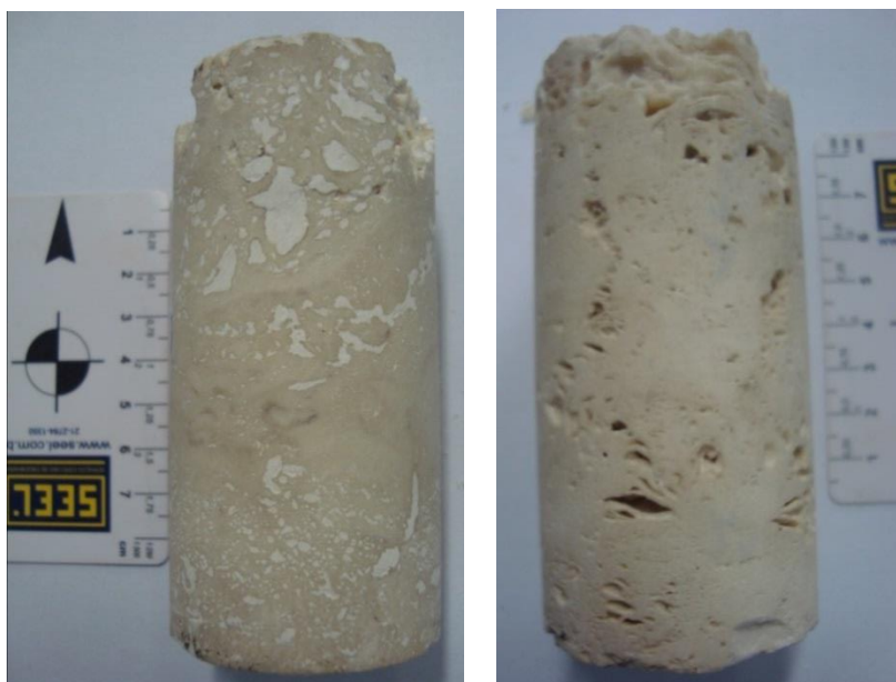
Figura 5.32 Corpos de prova testados com (TR3) e sem (TR13) a massa corrida preenchendo os poros.
