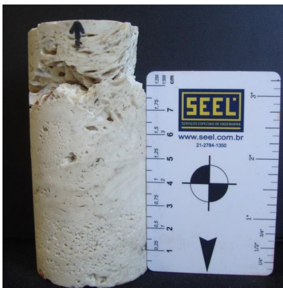
Figura 5.35 Corpo de prova TR 9 fraturado devido ao colapso de poros durante o ensaio de resistência uniaxial.
