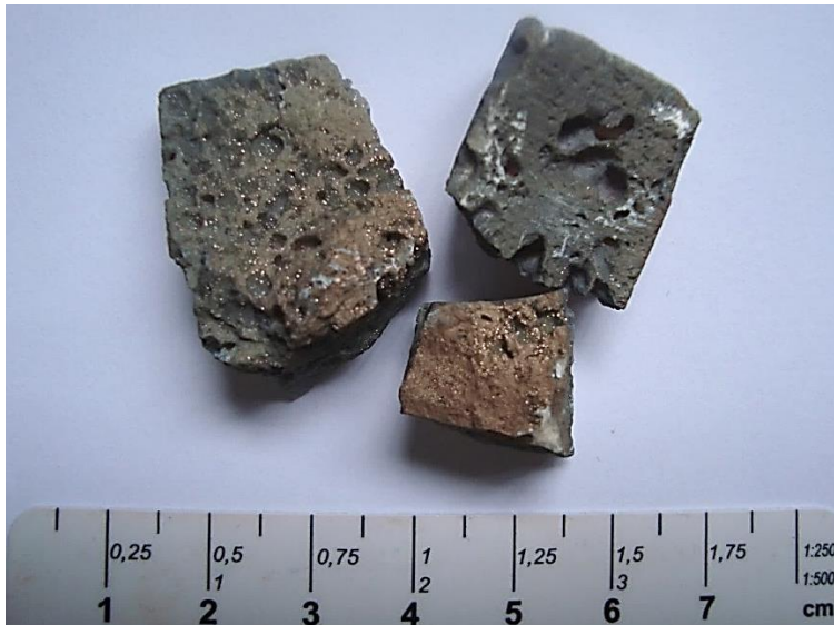
Figura 4.6 Amostras de mão metalizados em ouro prontas para ser usadas no MEV.
