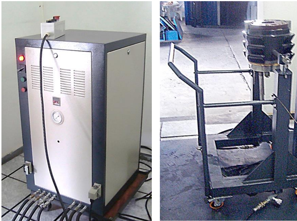
Figura 4.16 Unidade eletro-hidráulica (esquerda) e skid com a tampa da Célula triaxial (direita).
