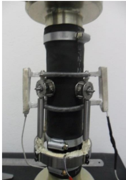
Figura 4.14 Corpo de prova instrumentado com Clip gage de deslocamento radial e axial.
