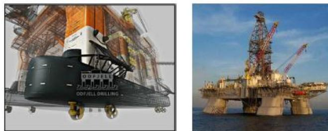
(b). Plataforma semi-submersível
