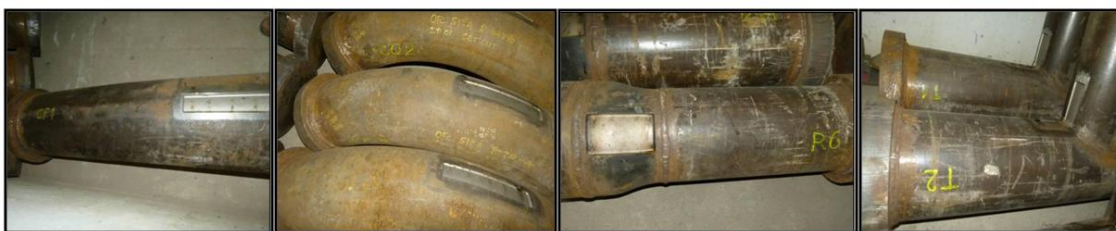
Figura 5.7 - Espécimes depois de serem feitos os rebaixos por eletro-erosão.
