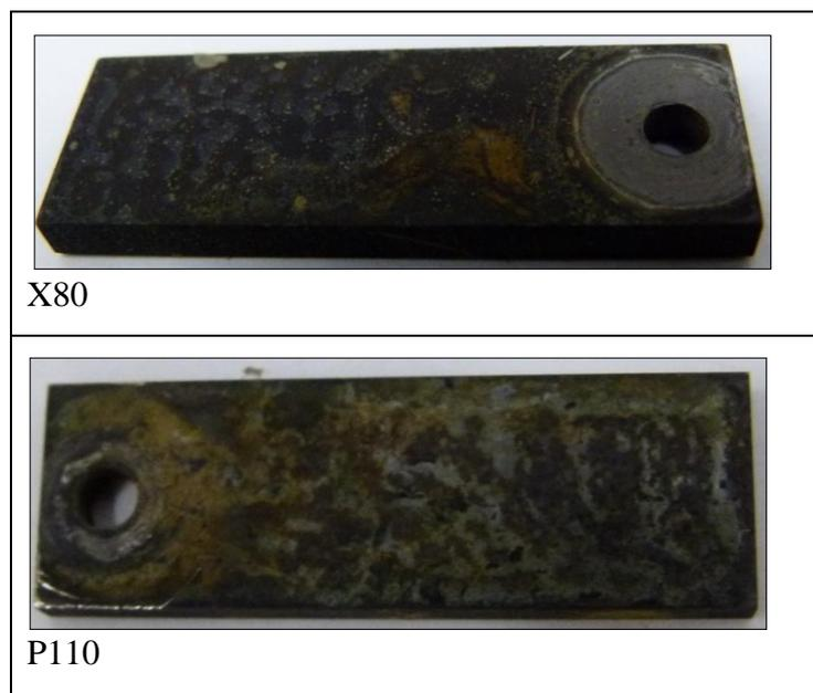
**Figura 5. 14- Aspecto da superfície dos corpos de prova retirados do vaso de pressão a 25°C após 15 dias de imersão.**
