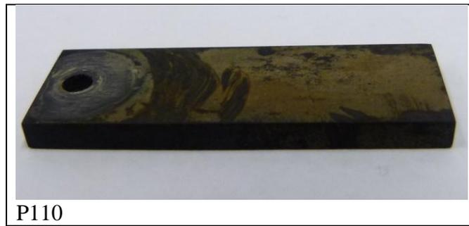
**Figura 5. 2- Aspecto da superfície dos corpos de prova retirados do vaso de pressão a 25°C após 7 dias de imersão.**
