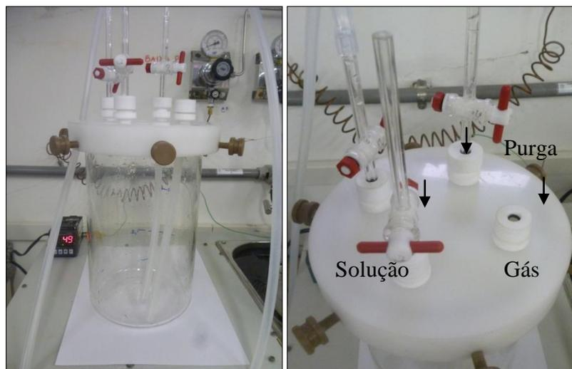
**Figura 4. 7- Vaso de transferência (a) vista frontal (b) vista superior.**
