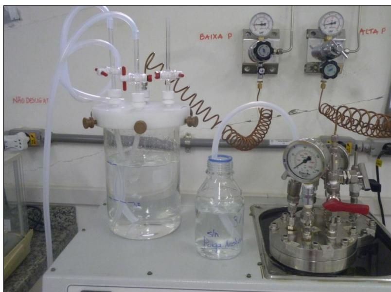
**Figura 4. 8 Montagem do vaso de pressão no processo de desaeração saturação e transferência da solução.**
