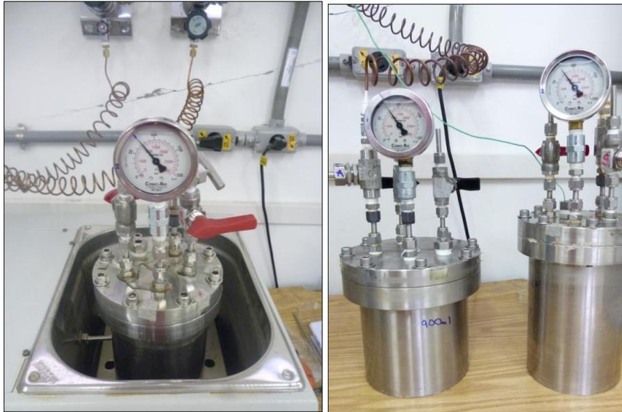
**Figura 4. 5- Vaso de pressão (a) vista frontal (b) vista superior.**
