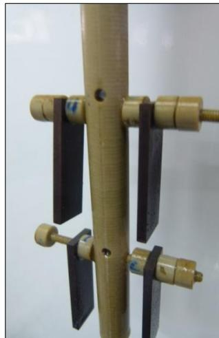
**Figura 4. 6- Posicionamento dos corpos de prova dentro do vaso de pressão. CP's para perda de peso.**
