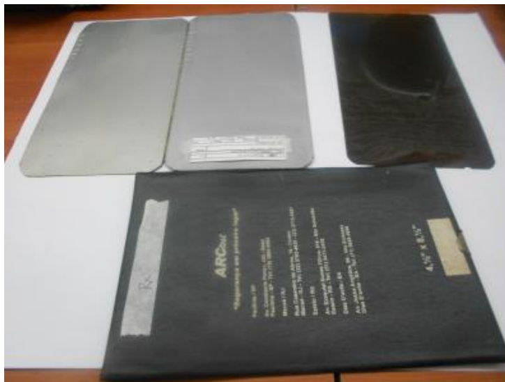
Figura 73 – Chassi, Tela intensificadora e filme.
