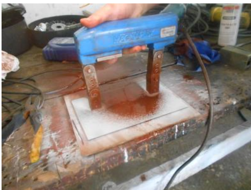
Figura 84 – Execução do ensaio por partículas magnéticas.
