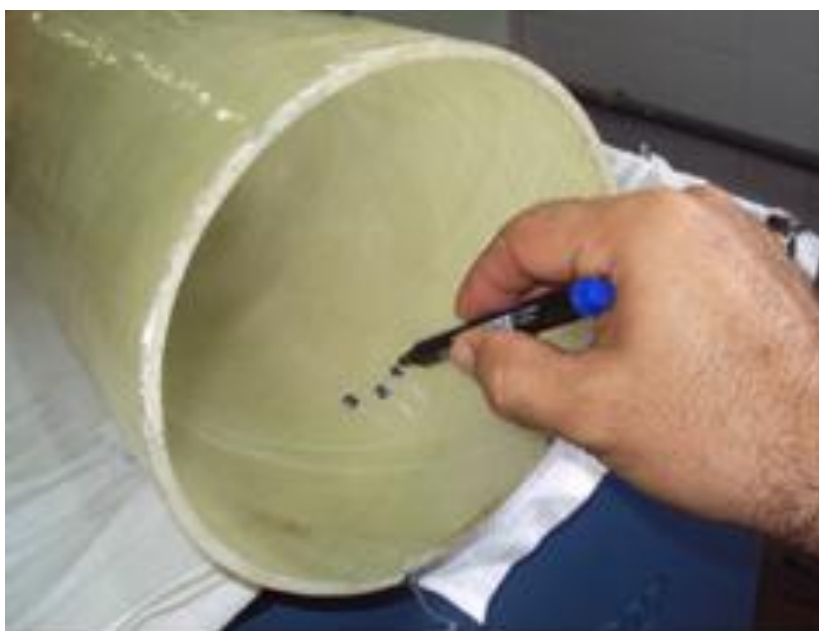
Figura 58 – Numeração de 1 a 3 nas descontinuidades.
