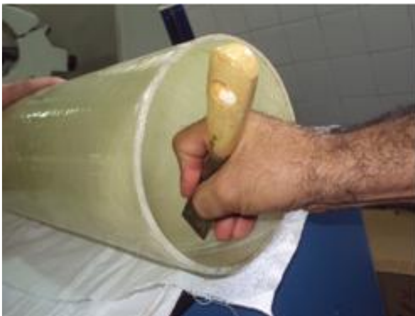
Figura 57 – Confeção de descontinuidades com auxílio de uma espátula.
