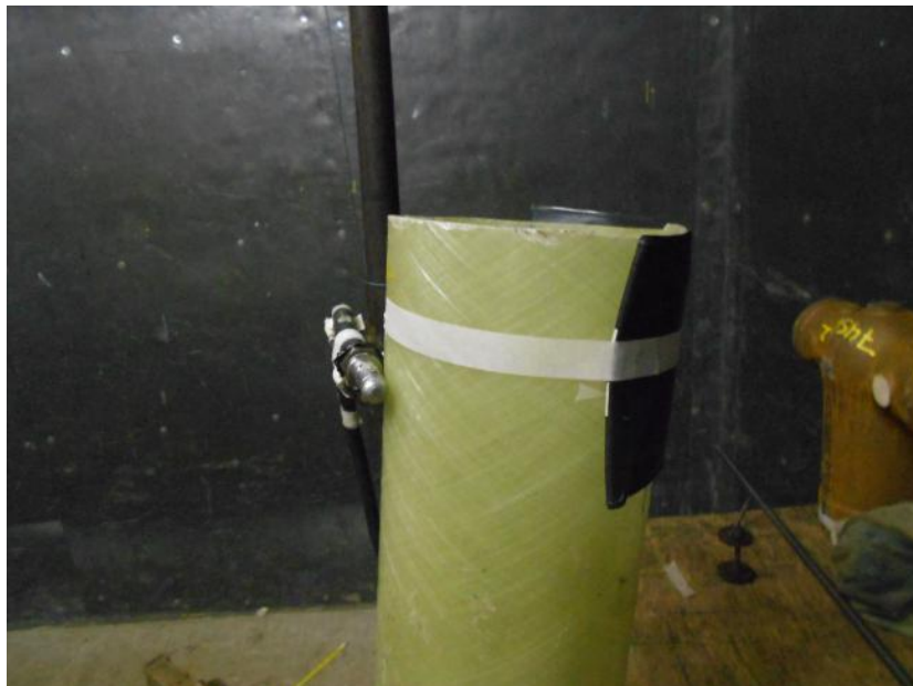
Figura 76 – Distância fonte filme na amostra do tubo compósito.
