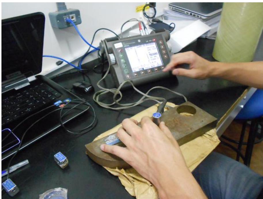
Figura 89 – Calibração do aparelho de ultrassom.
