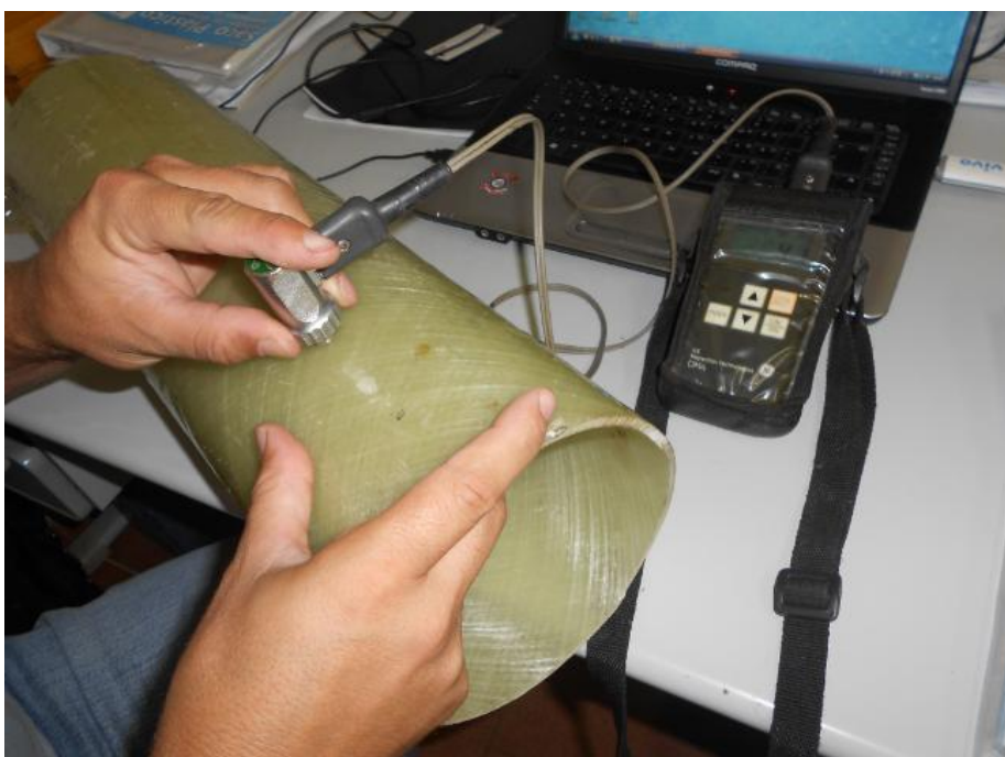
Figura 90 – Execução do ensaio por ultrassom pelo método medição de espessura na amostra do tubo compósito.
