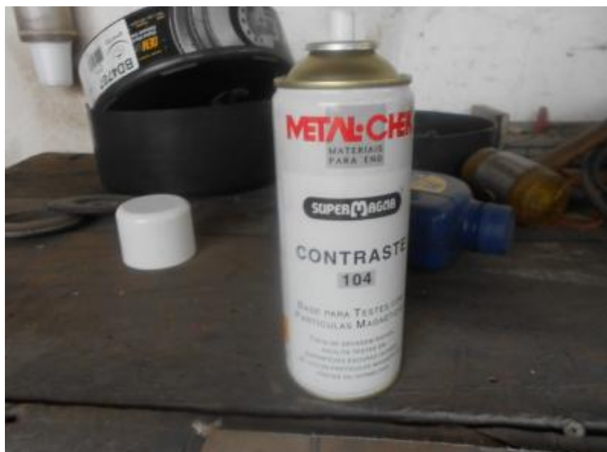
Figura 82 – Tinta de contraste usada no ensaio por partículas magnéticas.
