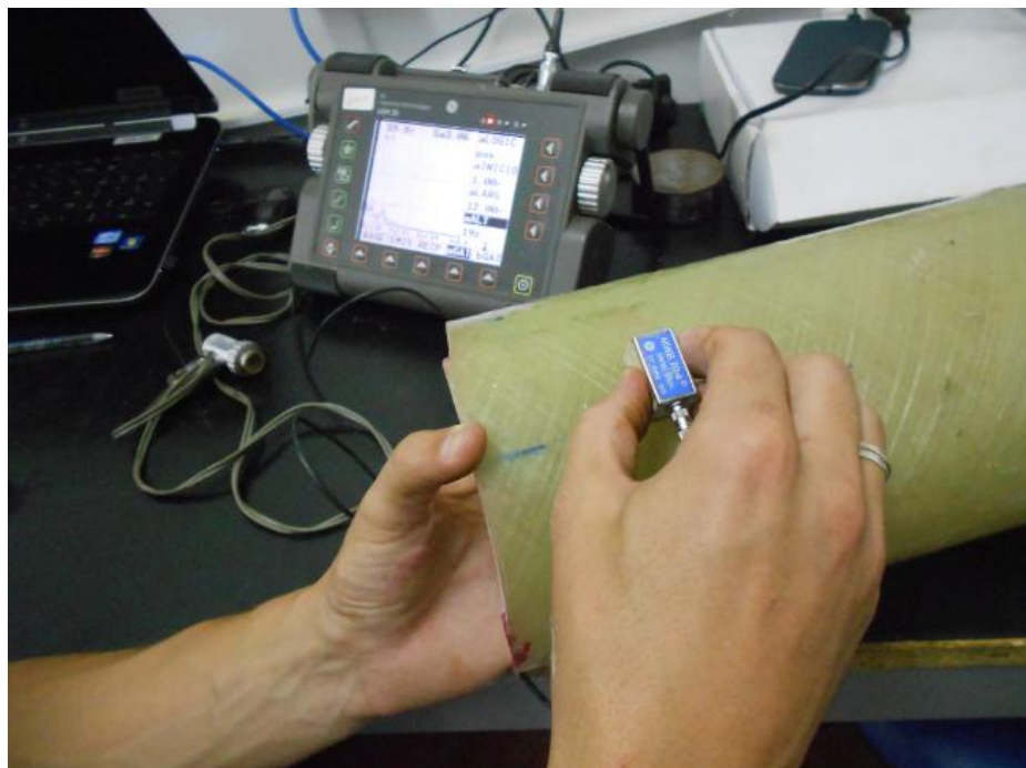
Figura 88 – Execução do ensaio por ultrassom método pulso eco na amostra do tubo compósito.
