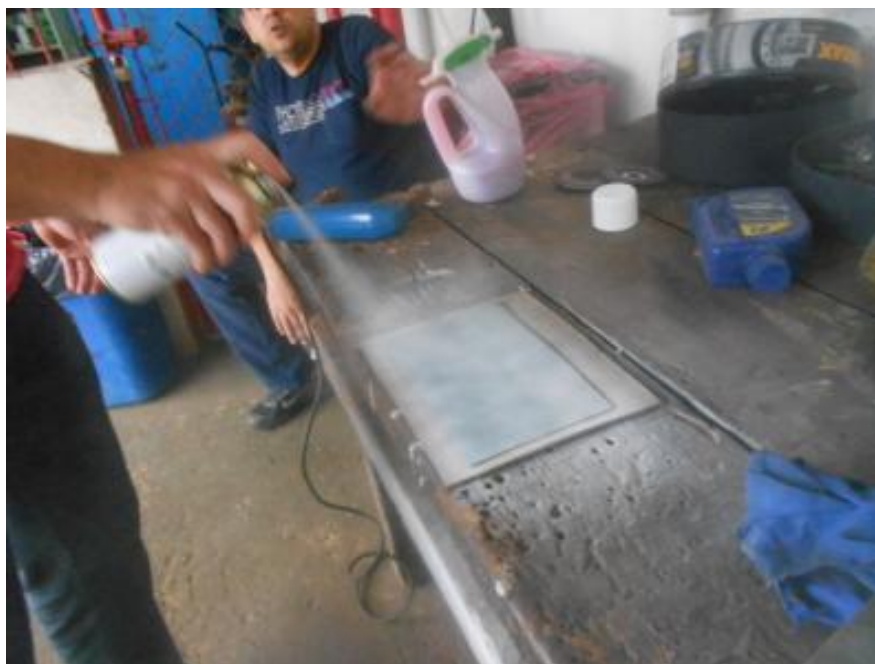
Figura 83 – Tinta de contraste sendo aplicada na amostra metálica.
