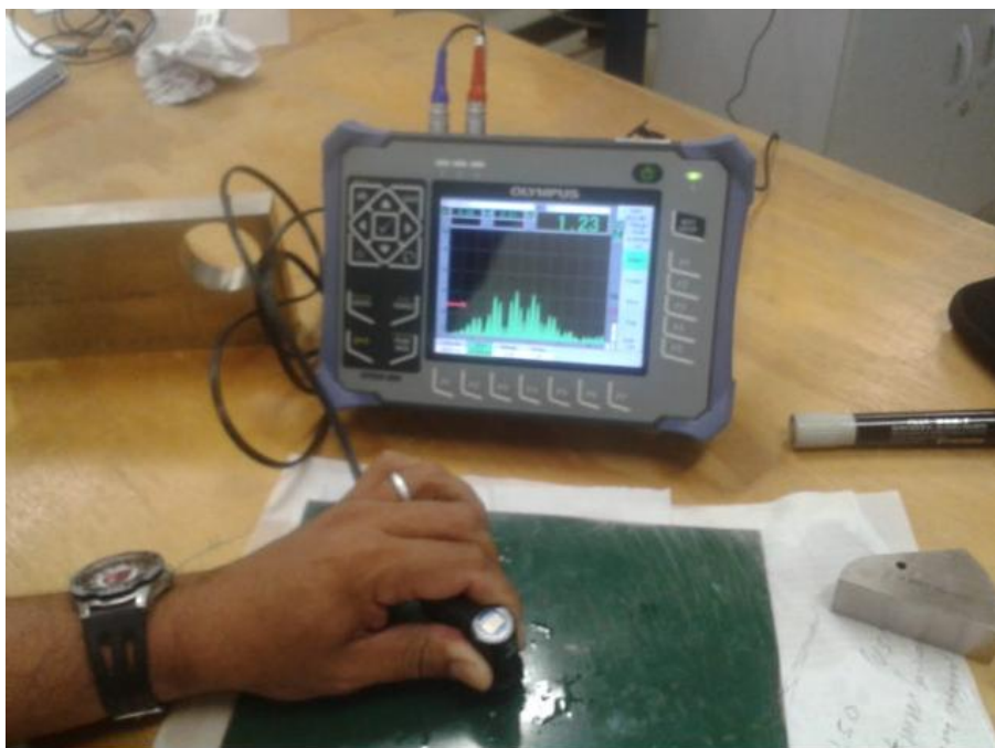
Figura 87 – Execução do ensaio por ultrassom método pulso eco na amostra metálica.
