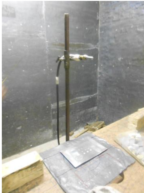
Figura 75 – Distância fonte filme na amostra metálica.
