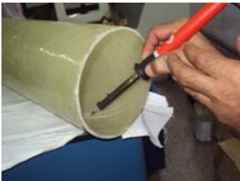
Figura 59 - Confeção das descontinuidades com o auxílio de um ferro de solda.
