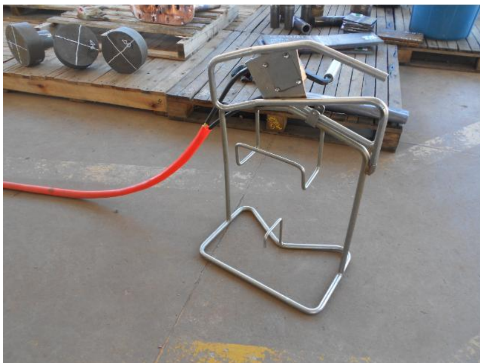
Figura 65 – Comando a distância para liberação dos isótopos.
