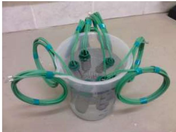
Figura 43: Sensor de matriz granular (GMS) saturando para ser colocado na área de estudo.
