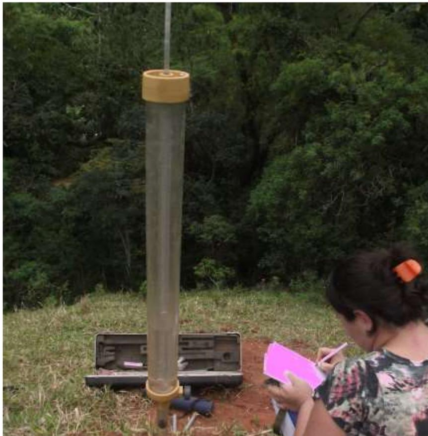
Figura 42: Permeâmetro e Guelph sendo utilizado em campo.
