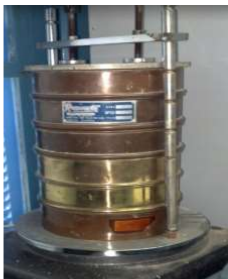
Figura 34: Conjunto de peneiras para ensaios de peneiramento onde são separados os grãos por sua distribuição granulométrica.
