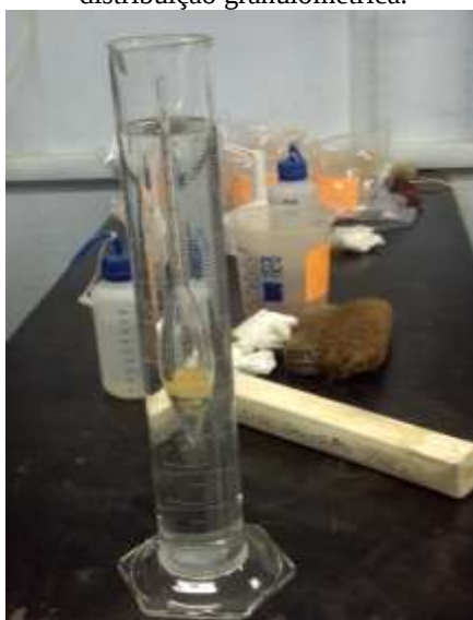
Figura 35: Densímetro na proveta em preparação para análise das frações finas por sedimentação.
