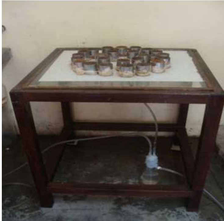
Figura 37: Mesa de tensão utilizada para determinação da macroporosidade, microporosidade e porosidade total.
