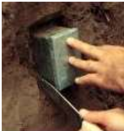
Figura 38: Amostra indeformada de solo, sendo retirada através da caixa de Kubiena.
