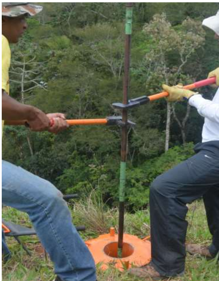
Figura 31: 1Trado mecânico sendo utilizado em alta encosta perfurando ao longo da profundidade da mesma para a retirada de material deformado.
