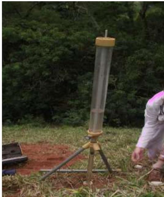
Figura 9: Permeômetro de Guelph sendo utilizado em campo na porção alta da encosta.
