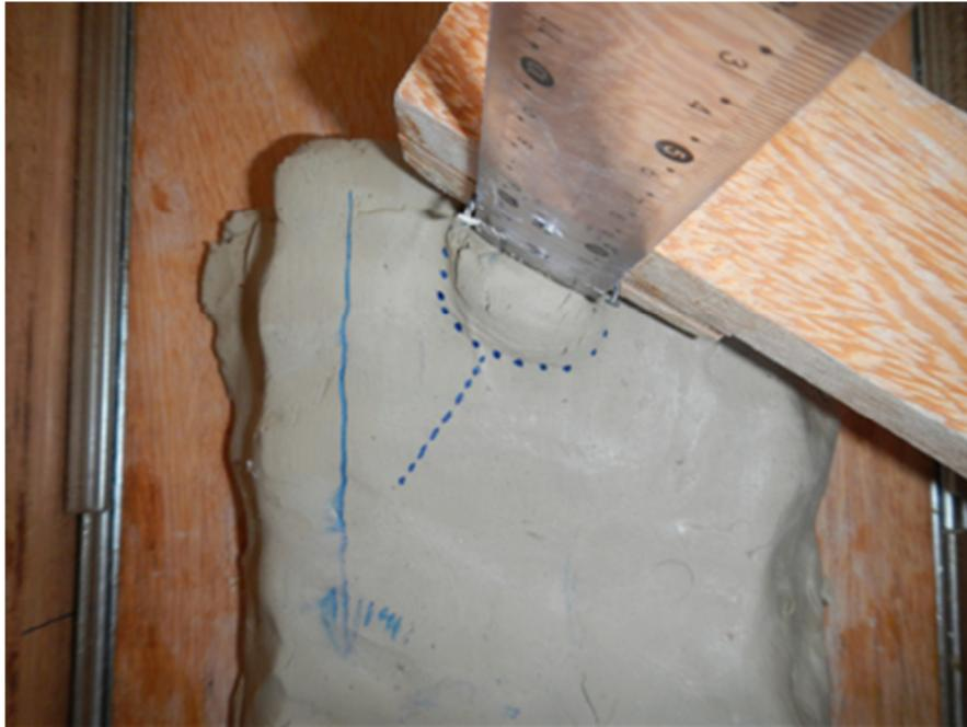
**Figura B.8:** Vista superior da falha da rocha no meio do corte e sua direção para um cortador com 30° *siderake*.
