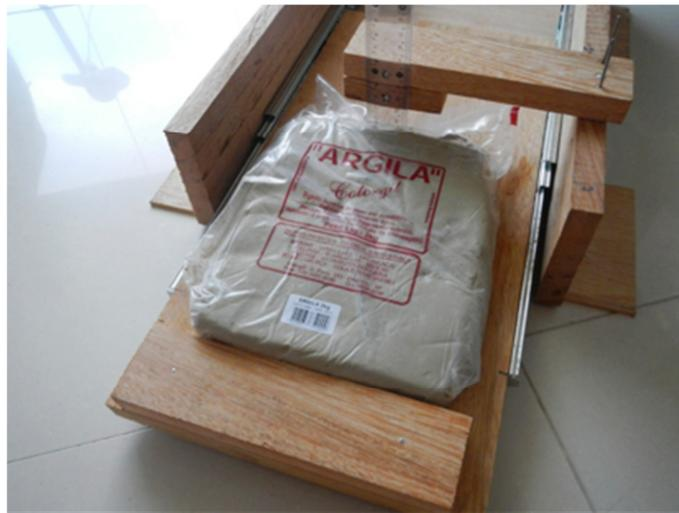
**Figura B.4: Demonstração do teste de cortador a ser realizado em argila.**
