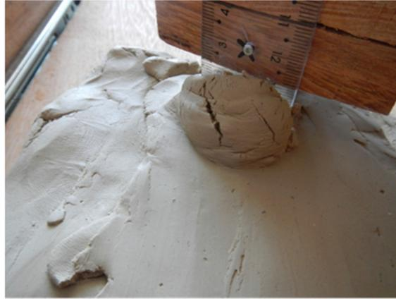
**Figura B.5: Formação do chip e estrias na superfície da argila no início do corte para um cortador com 30° *siderake*.**
