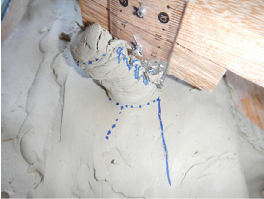
**Figura B.9:** Final do corte e direção da falha da argila para um cortador com  $30^\circ$  siderake.
