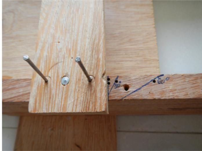
**Figura B.3: Pinos de segurança para evitar a rotação do suporte de cortador e furos que determinam a direção do *siderake*.**
