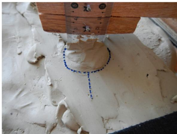
**Figura B.6: Direção da falha da rocha no meio do corte para um cortador com 30° *siderake*.**
