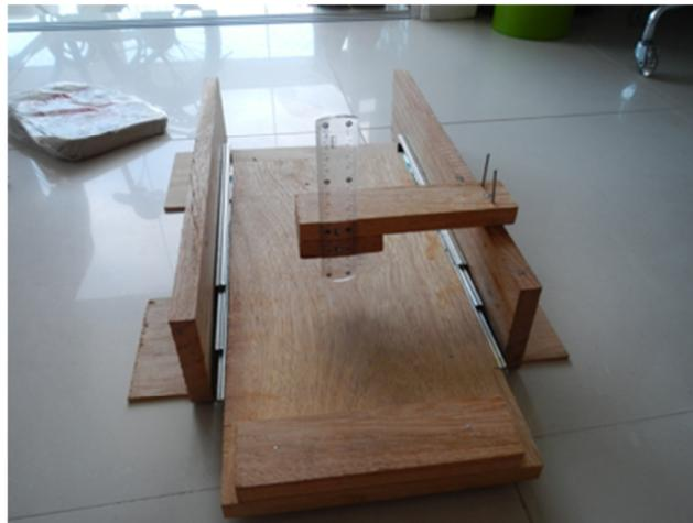
**Figura B.1: ‘Máquina experimental de corte’ montada para validar a solução do ângulo lateral de falha obtido.**
