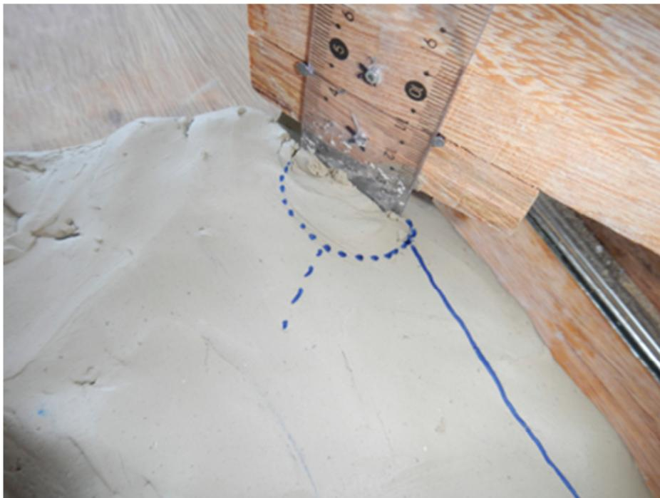
**Figura B.12: Início do corte para um cortador com  $60^\circ$  siderake e orientação da falha da argila em relação a direção de movimento.**
