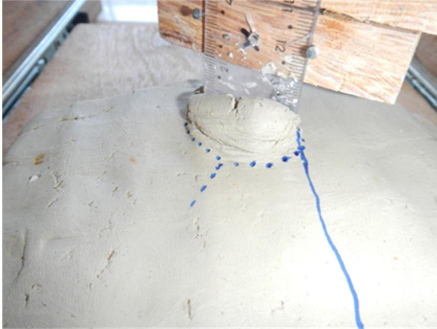
**Figura B.7:** Direção da falha da rocha no início do corte e sua direção com relação à direção do movimento para um cortador com 30° *siderake*.
