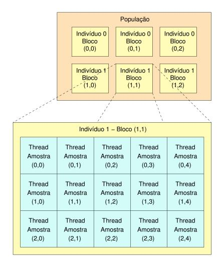
Figura 6.4: Níveis de paralelismo de Pseudo-assembly na GPU. Diferentes indivíduos são avaliados em paralelo por diferentes blocos de *threads*. Cada Bloco de *thread* avalia diferentes amostras de dados para o mesmo indivíduo em paralelo.
