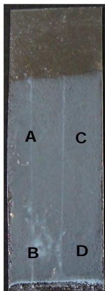
Figura 4.4- Imagem do revestimento feito por imersão com o nanopó AM-1 sobre uma lâmina de vidro tratada com HF.
