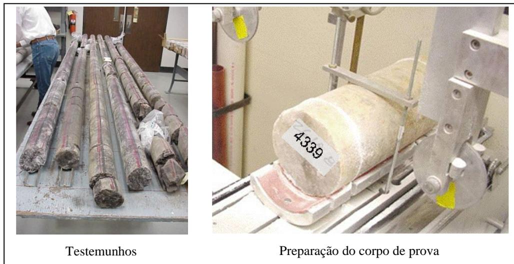
Figura 2.14 – Amostragem de rocha salina - testemunhagem e preparação do corpo de prova (Lee & Ehgartner, 2001).
