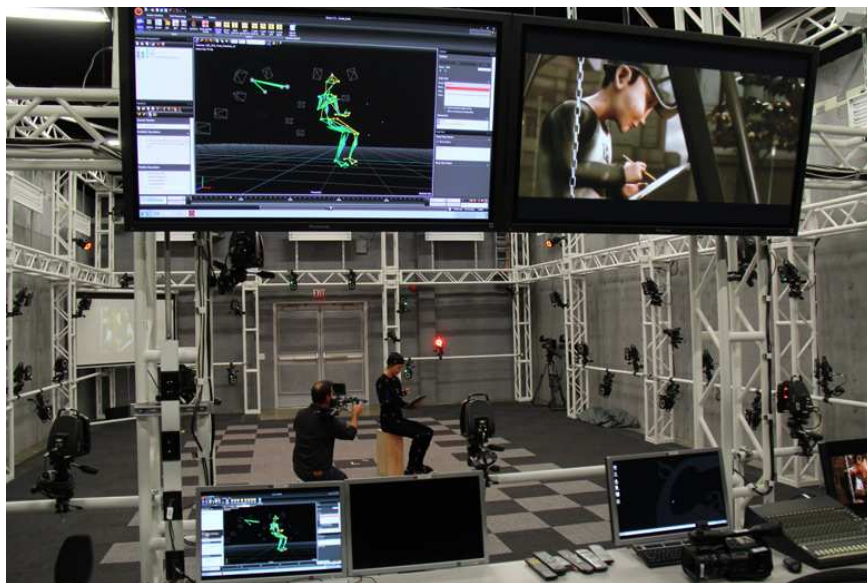
Figura 44 - Estúdio com ambiente neutro e iluminação controlada para captura de movimentos através de sistema óptico
